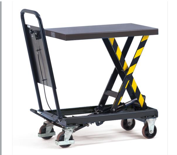
Profilstahl-/Stahlblech-Konstruktion, pulverbeschichtet anthrazitgrau RAL 7016. Kräftiger Rohrschiebebügel. Hydraulikpumpe mit verchromten Kolben. Betätigung über Fußpedal. Senkventil über Handhebel feinfühlig zu betätigen. Plattform 50 mm hoch. 2 Lenk- und 2 Bockrollen, Räder Polyurethan-Bereifung, Lenkrollen mit Feststeller. 2 Jahre Garantie
