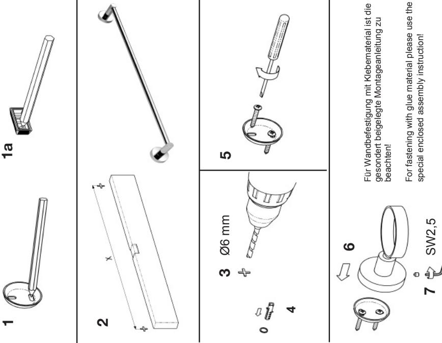
Für Wandbefestigung mit Klebematerial ist die geconent beigegte Montageanleitung zu beachten! Für fassering mit glue material please use the special enclosed assembly instruction!
