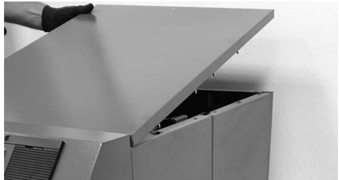
Abb. 4: Demontage der oberen Verkleidung
