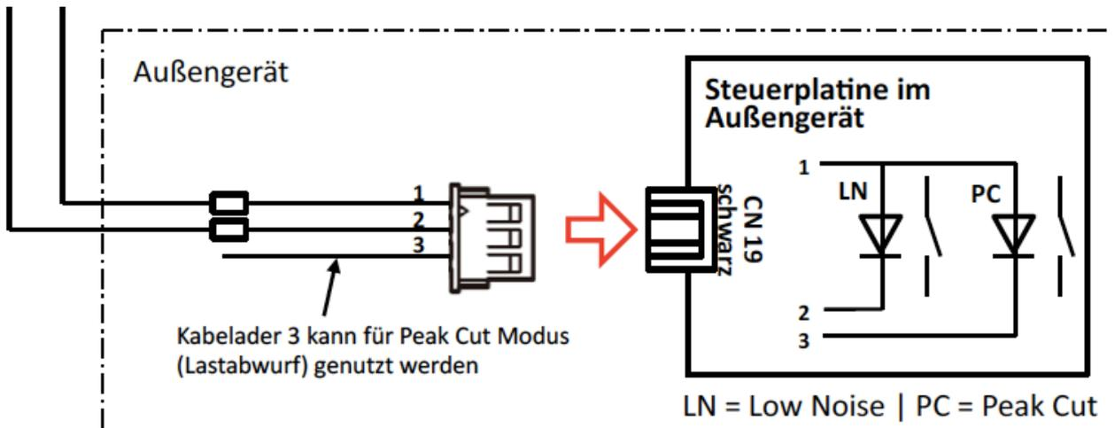
Der 3-aderige Stecker wird auf Steckplatz CN19 auf der Steuerplatte am Außengerät eingesteckt. Es ist richtig, dass der weiße Stecker in die schwarze Steckbuchse CN19 kommt. Den Stecker nicht in CN18 einstecken, da sonst keine Funktion.
