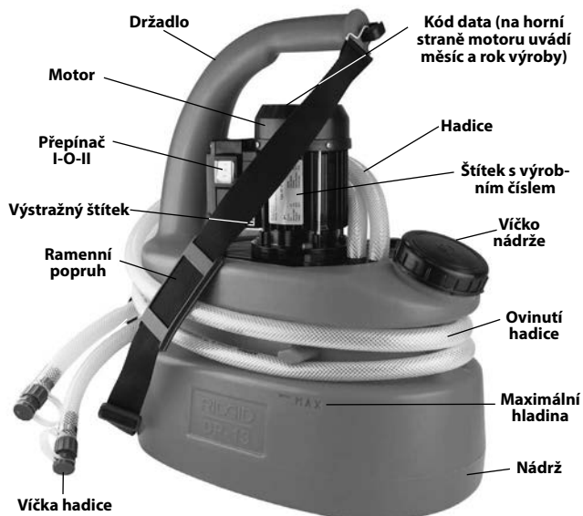
Obrázek 1 – Čerpadlo na odstraňování vodního kamene RIDGID DP-13
