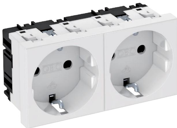
Schutzkontakt-Steckdose 2-fach 0°, mit erhöhtem Berührungsschutz, mit Steckklemmen, 2-polig, 16 A, 250 V~, mit Verbindungsklemmen nach IEC 60884-1.
