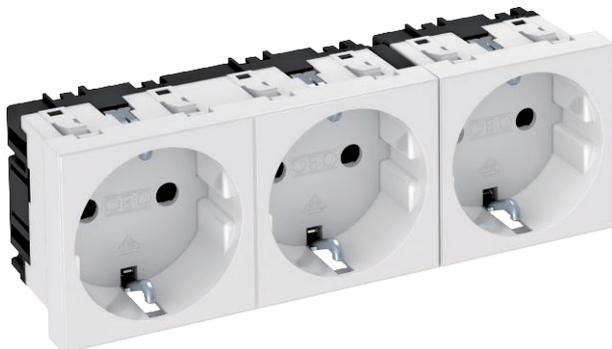
Schutzkontakt-Steckdose 3-fach 0°, mit erhöhtem Berührungsschutz, mit Steckklemmen, 2-polig, 16 A, 250 V~, mit Verbindungsklemmen nach IEC 60884-1.
