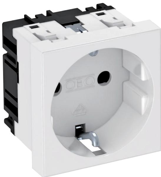
Schutzkontakt-Steckdose 1-fach 0°, mit erhöhtem Berührungsschutz, mit Steckklemmen, 2-polig, 16 A, 250 V~, mit Verbindungsklemmen nach IEC 60884-1.
