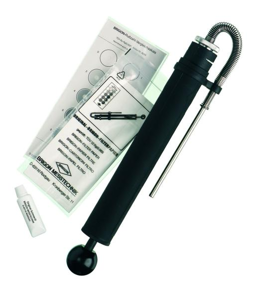
Die Rußprüfmethode besteht darin, dass eine bestimmte Rauchgasmenge aus dem Verbindungsstück zwischen Feuerstätte und Schornstein hinter dem Wärmeaustauscher im Kern des Rauchgas-Stromes entnommen und durch ein spezielles Filterpapier geleitet wird. Der dabei entstehende Rußfleck wird mit den unterschiedlich geschwärzten Flächen der Rußbild-Vergleichs-Skala verglichen und die Rußzahl bestimmt.
