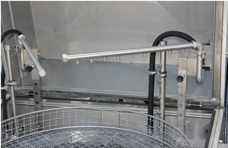
HTW Max Eco – höhenverstellbarer Düsenstock für Reinigung und Luftdusche
