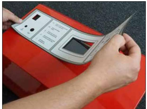
Beispiel der Beklebung des Gerätegehäuses mit Selbstklebern
