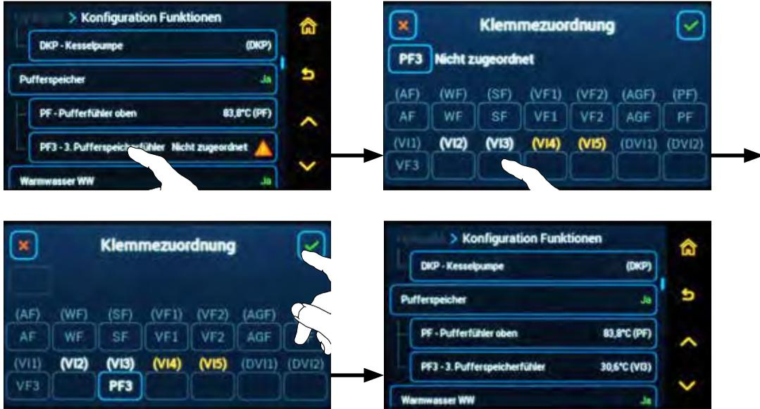
Beispiel: **Zuordnung der Klemme - des Ausgangs** - beim Hinzufügen der Elektroheizung des Pufferspeichers EHP.
