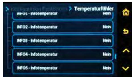
Der Regler ermöglicht, einen Außenfühler (AF2) für eine bessere Steuerung der Heizkreise sowie weitere Informationsfühler (INFO1 und INFO5) zusätzlich zu installieren.
