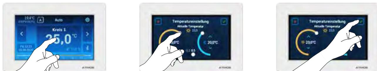
Die Temperatur im Raum wird durch die Eingabe eines konkreten Wertes auf dem Touchscreen geändert.
