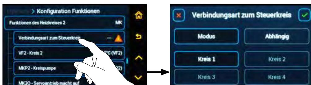
Die Einstellung der Funktion **Art der Kopplung an den Kreis** ist erst nach ihrer Aktivierung im Untermenü **Hydraulik/Konfiguration Funktionen/Funktionen des Heizkreises 2/Kopplung an den Steuerkreis = Ja** möglich (sichtbar).
