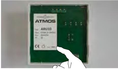
Dadurch wird die Raumgerät ARU10 mit dem Regler ACD03/04 automatisch gepaart, was durch die Änderung der LED-Anzeige am Raumgerät ARU10 **Anzeige des aktuell eingestellten Betriebsmodus** sichtbar ist.
