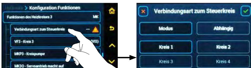
Die Einstellung der Funktion **Art der Kopplung an den Kreis** ist erst nach ihrer Aktivierung im Untermenü Hydraulik/Konfiguration Funktionen/Funktionen des Heizkreises 3/Kopplung an den Steuerkreis = **Ja** möglich (sichtbar).
