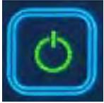
**Kombikessel mit Brenner (manuell/auto)** - Die Taste
