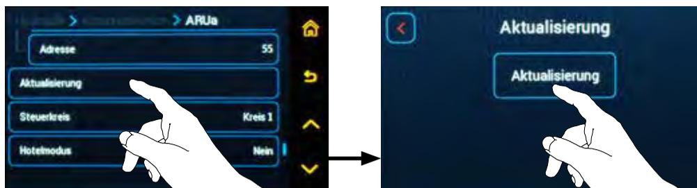
Beim Raumgerät ARU10 dauert **die Aktualisierung 30 s** und wird am Raumgerät durch das gleichzeitige Blinken der 1. und 2. oder der 3. und 4. LED-Kontrollleuchte angezeigt.
