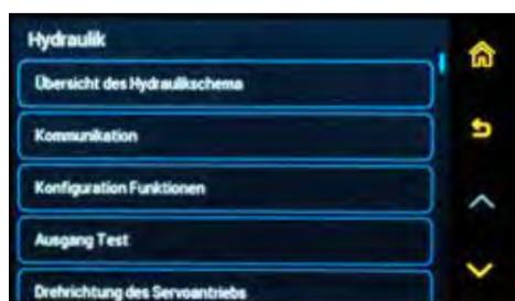
Unter der Taste **Kommunikation** die Taste **Raumgeräte** drücken (⚙️→🔊🔗 Hydraulik/Kommunikation/Raumgeräte). Das gewünschte Raumgerät wählen und es durch Einstellung auf **Ja** aktivieren
