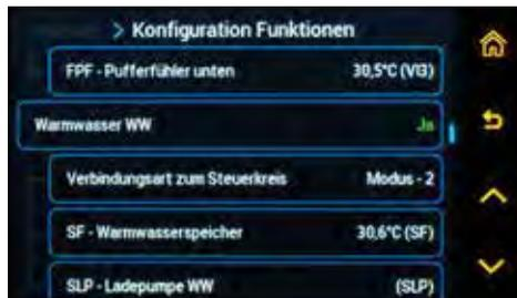
Die Aktivierung oder Deaktivierung der Steuerung der Warmwasserladung (WW) wird im Untermenü durchgeführt.
