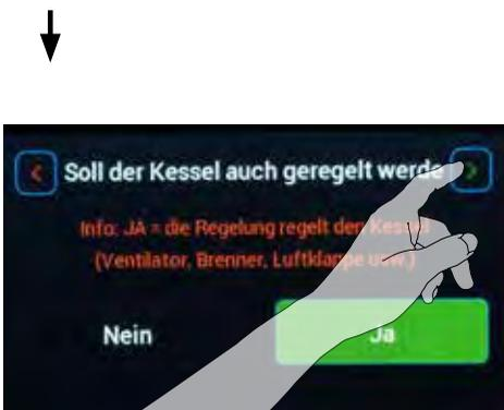
Möchten Sie, dass **die Regler ATMOS ACD 03/04 den Kessel** (Ventilator, Brenner, Luftklappe usw.) **selbst steuern?**
