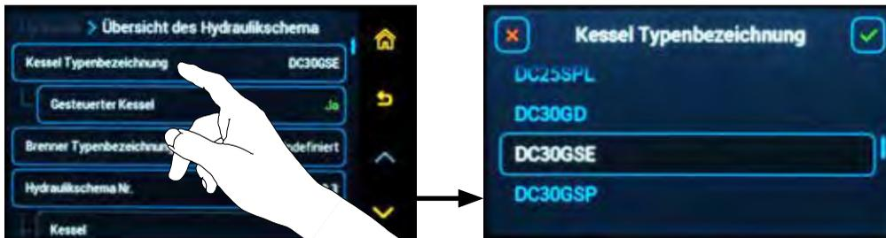
**Gesteuerter Kessel** – mit einem Regler gesteuerter Kessel (**Ja/Nein**) – diese Taste ermöglicht, die Funktion zu ändern.
