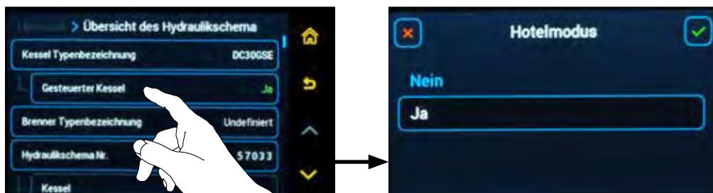
**Bezeichnung des Brennertyps** (z. B. A25) – die Taste (aktive Zeile) ermöglicht, einen anderen Brenner aus der Liste auszuwählen.
