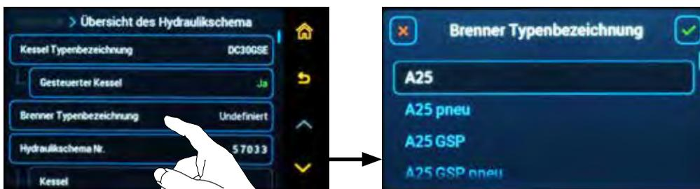
**Hydraulikschema-Nummer** - das ausgewählte Hydraulikschema - die Taste ermöglicht, das Hydraulikschema (Nummer) zu ändern.
