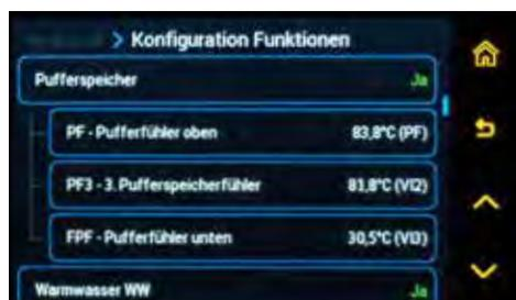
**Fühler PF – Pufferspeicherfühler oben** (Fühler NTC 20 kΩ) - Temperatur, die für die Betriebssteuerung des ganzen Heizsystems notwendig ist. Sie ist besonders wichtig für das Einschalten von Kesselkreispumpe, WW-Pumpe und Heizkreisen (siehe Menü Pufferspeicher).
