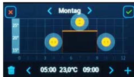
Ist der Parameter P07<sup>System</sup> auf AUS eingestellt, haben alle Zeitblöcke einen gleichen Wert für Komfort-Temperaturen, der der unter der ⏴-Schaltfläche eingestellten Komfort-Temperatur ☼ entspricht.
