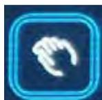
**Kombikessel mit Brenner (manuell/auto)** - Die Taste
