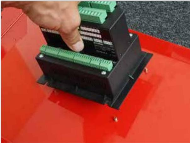
Setzen Sie den Regler auf die vier M4 Schrauben
