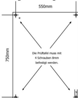
Vorhandene Bohrungen in der Prüftafel-Rückwand
