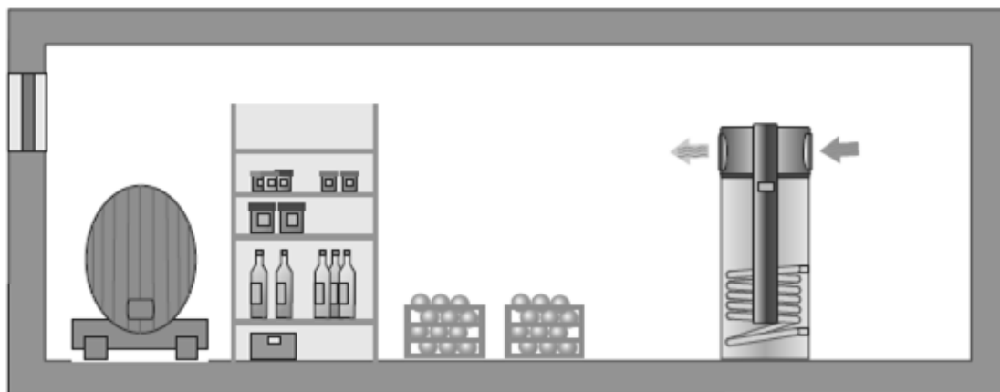
Abbildung 1: Die Luft wird aus dem selben Raum abgesaugt und in denselben Raum ausgeblasen (z.B. geeignet für die Kühlung des Raumes).
