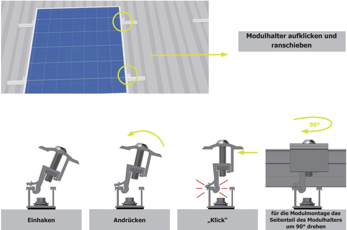
Schieben Sie nun das nächste Modul unter den Modulhalter, passen Sie den Modulhalter an die Modulrahmenhöhe an und ziehen Sie die Schrauben fest (Anzugsmoment 8-10 Nm).
