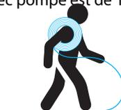
Un tube de chauffage au sol est livré sous forme de rouleau et est donc soumis à une tension. Pour éviter que le tube de chauffage ne se redresse sous l'effet de cette tension lorsqu'il entre dans la tranchée, il convient de dérouler le rouleau dans la direction opposée (voir photo). Cette méthode annule la tension dans une large mesure.
