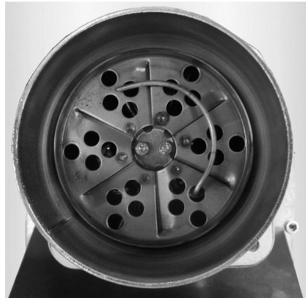
Abb. 33: Position Ionisationselektrode SGN(F) 44-66/2
