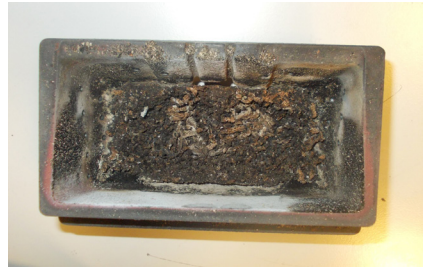
BEISPIEL VERSCHMUTZTE BRENNSCHALE
