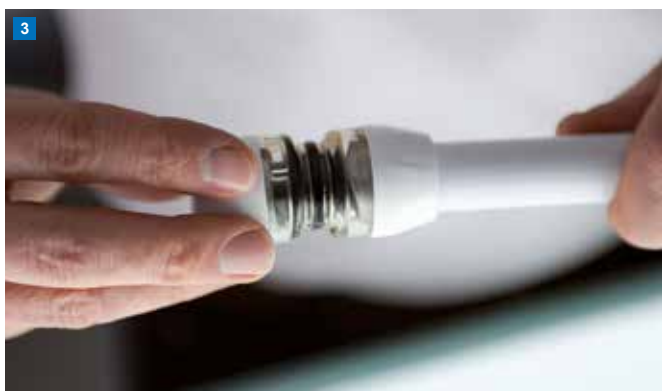
Verpressen Der Pressvorgang wird durch Einschieben des Rohres bis zum Klick-Geräusch ausgelöst.
