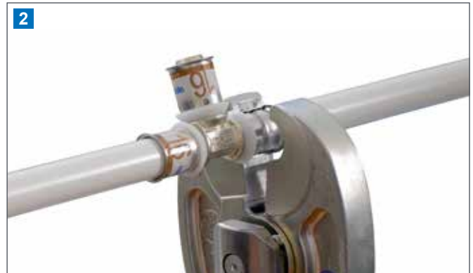
2 Die Pressbacke mit der gleichen Farbcodierung wie der Fitting wird an die Pressbackenführung der Edelstahl-Presshülse angelegt.
