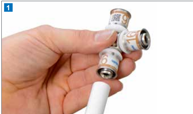
1 Uponor Verbundrohr in den Fitting einstecken. Das Rohrende muss zuvor nicht kalibriert und entgratet werden.
