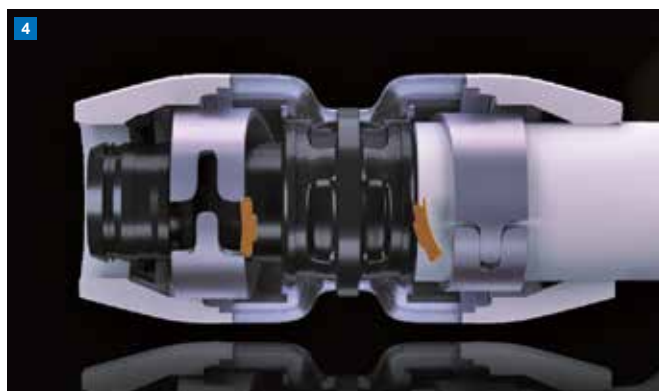
Prüfen Die erfolgreiche Verpressung ist durch das Klarsichtfenster erkennbar. Der farbodierte Abstandhalter wurde durch das Rohrende aus dem vorgespannten Press-Ring geschoben, der Press-Ring ist geschlossen
