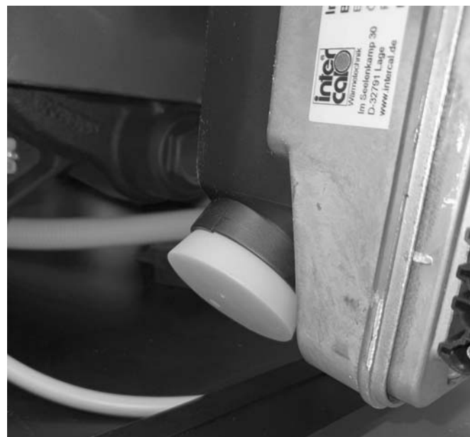
Abb. 8: Zuluftstopfen im Ansaugschalldämpfer
