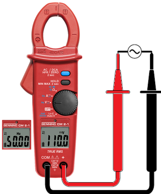
Illustration 10: Mesure de tension alternative et de fréquence
