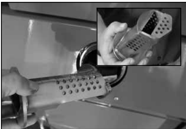
Die Zünd- und Blindkammer herausnehmen
