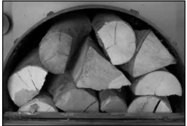
Die richtig befüllte Kammer im Detail
