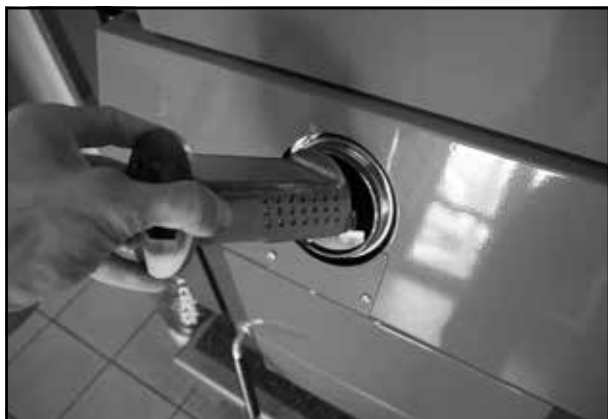
Die Zündkammer in den Kessel einstecken
