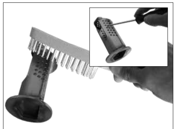
Die Reinigung des Zündkammer
