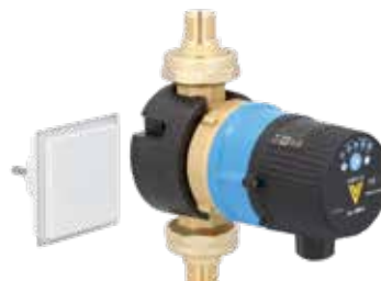
BWO 155 V MA • Verschr. DN 32 (1 1/4") ÜWW x DN 15 (1/2") Außengewinde • Lötanschluss ø 15 mm • Inkl. Rückschlagventil, Kugelabsperrhahn und Wärmedämmschale
