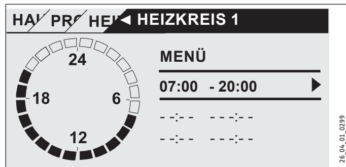
Sie können pro Tag oder Zeitblock drei Schaltzeitpaare einstellen. Die Schaltzeitpaare werden in der Anzeige rechts neben der Uhr aufgelistet. Jedes Schaltzeitpaar besteht aus einer Start- und einer Endzeit.
