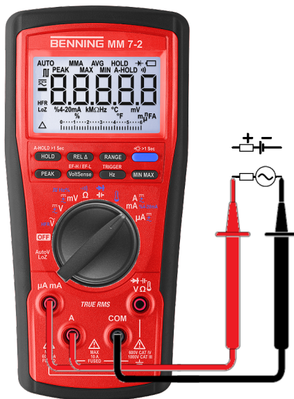
Abb. 10: Strom- oder Frequenzmessung
