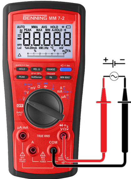
Abb. 9: Spannungs-, Frequenz- oder Tastverhältnismessung
