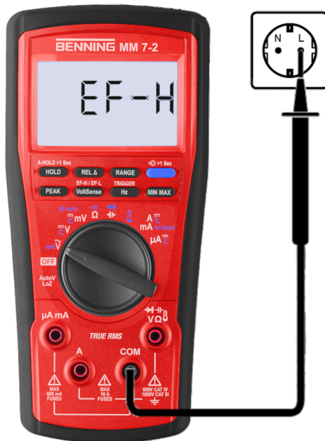
Abb. 15: Außenleiter- oder Phasenprüfung
