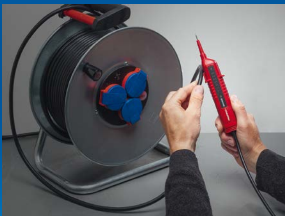
Lokalisierung von Kabelbrüchen
