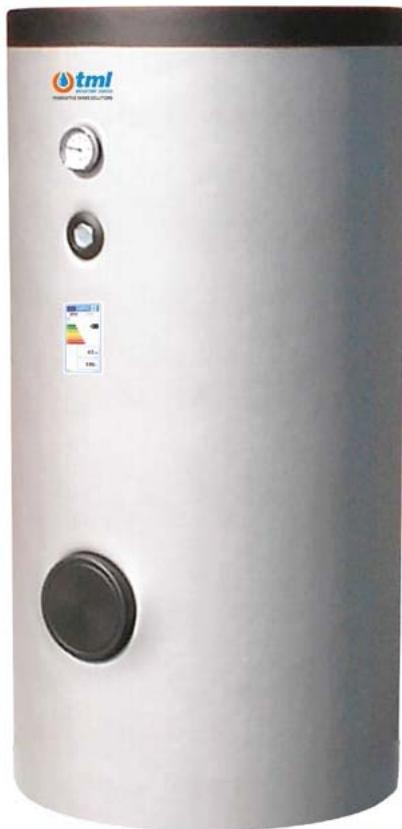
Préparateurs construits en acier au carbone émaillé pour la production et le stockage d'eau chaude sanitaire (ECS). Ils sont équipés d'un ou deux échangeurs de chaleur internes à serpentin fixe pouvant être alimentés par une pompe à chaleur et un système solaire. L'échangeur de chaleur spécial à double serpentin parallèle permet une transmission plus efficace de la puissance fournie par la pompe à chaleur dans les parties les plus froides du
