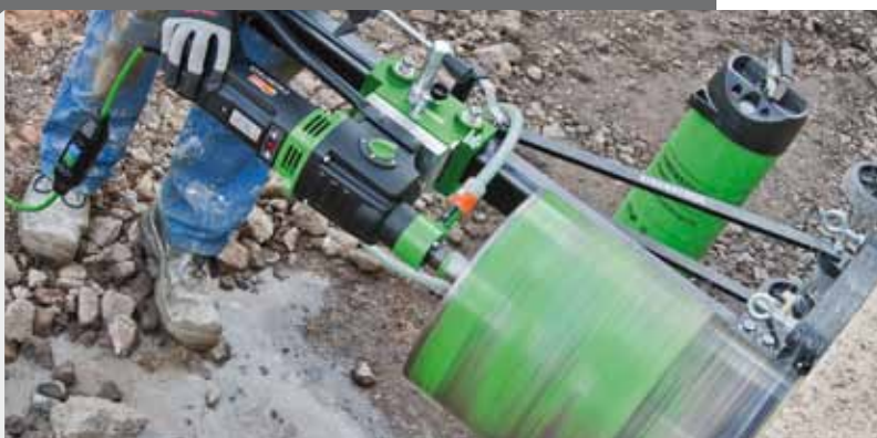
BST 352 V: auf vier Spezialkugeln gelagerter Schlitten
