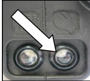
De plus, vous disposez d'un voyant de service sur le capuchon du moteur, qui signale à l'avance que la machine est sur le point d'user les balais de carbone. Après éclairage du voyant, vous pouvez utiliser l'outil pendant environ 1 jour. Puis, faites remplacer les balais de carbone.
