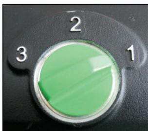
La **EBM 352/3** est équipée d'une boîte à 3 vitesses dans un bain d'huile. Adaptez la vitesse de rotation en fonction du diamètre du trou (voir la plaque signalétique).
