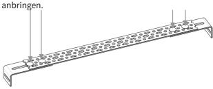
Befestigungswinkel in gewünschter Höhe auf beiden Seiten mittels Blechschrauben am Profil befestigen.
