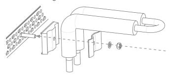
Rohrbogen mit Klemmsystem gemäß Abbildung aufstecken und Mutter aufschrauben.
