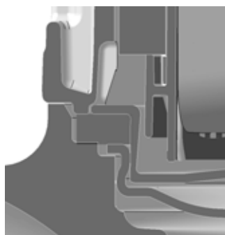
Abb. 37 Schnittzeichnung zur Veranschaulichung des Dichtungsprinzips
