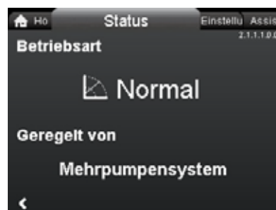
Abb. 54 Beispiel für das Untermenü "Betriebsstatus", in dem zu sehen ist, dass die Pumpe im Normalbetrieb in einer Mehrpumpenanlage läuft.
