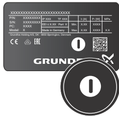
Abb. 45 Identifizieren des Masterpumpenkopfs mit dem Typenschild
