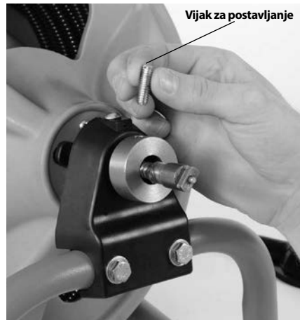
Slika 3 – Uklonite i odbacite sigurnosni utični vijak sajle
