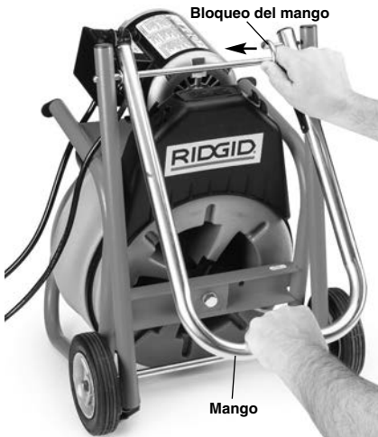
Figura 9 – Operación del mango
