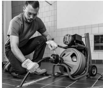
Figura 16 – Utilizarea mașinii cu furtun de ghidare
