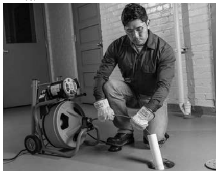
Obrázok 10 – Príklad predĺženia odtoku do vzdialenosti 2' (0,6 m) od otvoru špirály
