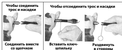
Рис. 12 – Подсоединение/отсоединение инструмента
