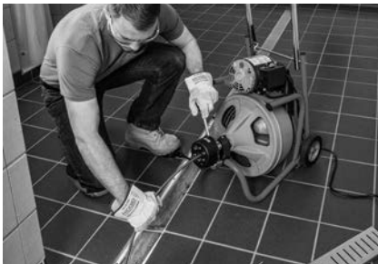
Figur 15 – Betjening af K-400 med AUTOFEED-enheden
