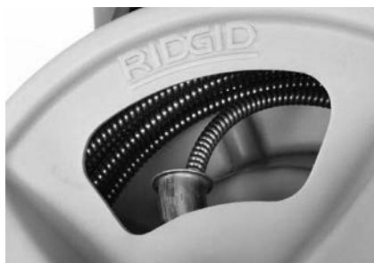
Slika 18 – Kabel tuljave v boben, kot je prikazano
