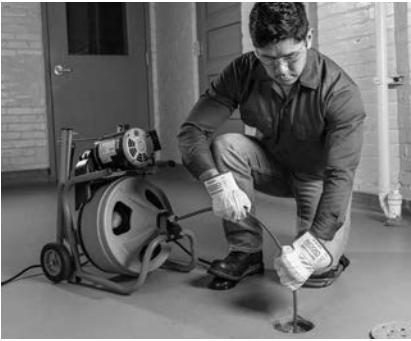
Figura 13 – Em Posição de Funcionamento, Avanço Manual do Cabo
