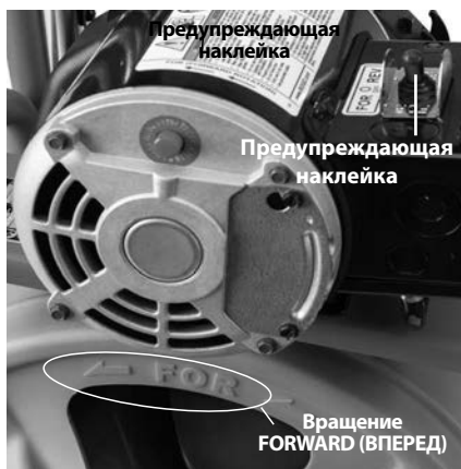
Рис. 8 – Надлежащее вращение барабана (Положение переключателя ВПЕРЕД)
