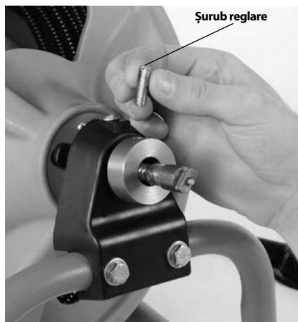
Figura 3 – Îndepărtați și aruncați șurubul de blocare a cablului
