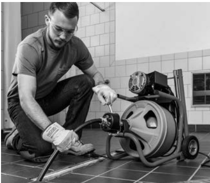
Obrazek 16 – Použití stroje s vodící hadicí
