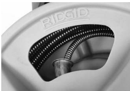
Figur 18 – Sno spiralen ind i tromlen som vist
