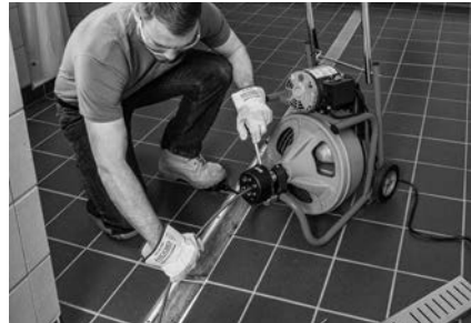
Obrázok 15 – Prevádzka stroja K-400 s mechanizmom AUTOFEED
