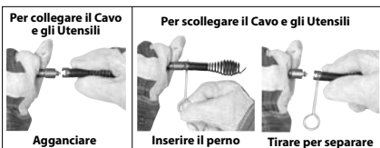
Figura 12 – Connessione/disconnessione degli utensili
