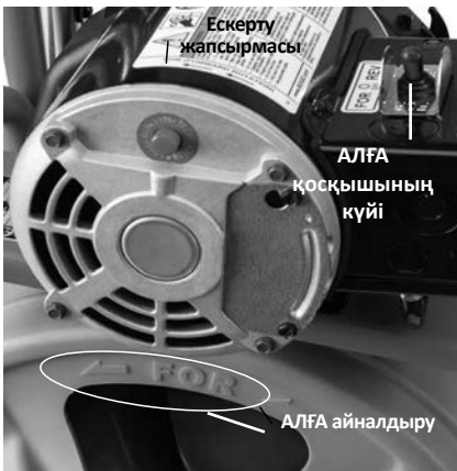
8-сурет – Барабанның дұрыс айналуы (АЛҒА қосқышының күйі)
