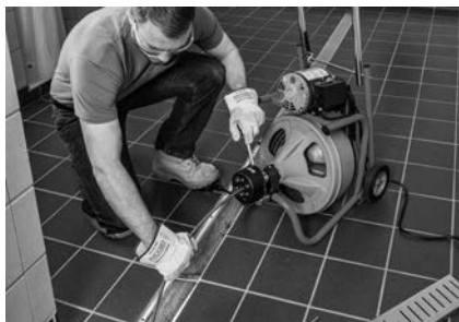
Figura 15 – Attivazione della K-400 con Direzioni dell'AUTOFEED
