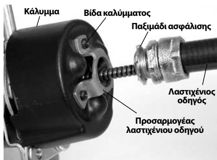
Εικόνα 6 – Τοποθέτηση λαστιχένιου οδηγού στο σύστημα τροφοδότησης σπιδάλ
