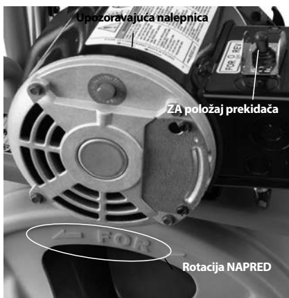
Slika 8 – Pravilno okretanje bubnja (pozicija prekidača FOR)
