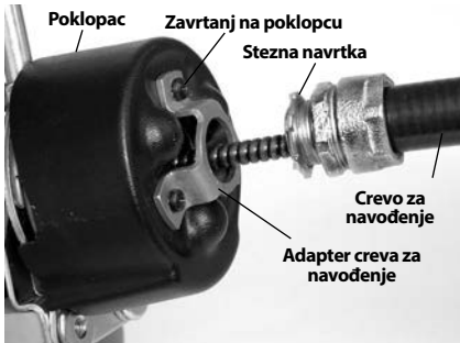
Slika 6 – Montaža creva za navođenje na dovod sajle
