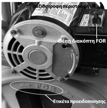
Εικόνα 8 – Ορθή περιστροφή τυμπάνου (Θέση διακόπτη FOR)
