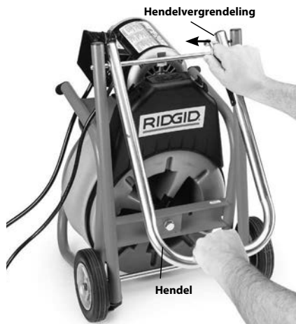
Figuur 9 – Bediening van de handgreep
