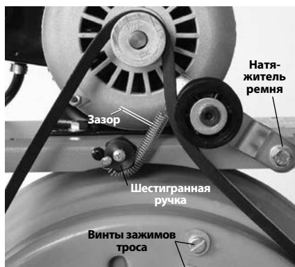
Рис. 17 – Регулировка ограничителя крутящего момента. (Показано со снятым кожухом ремня)
