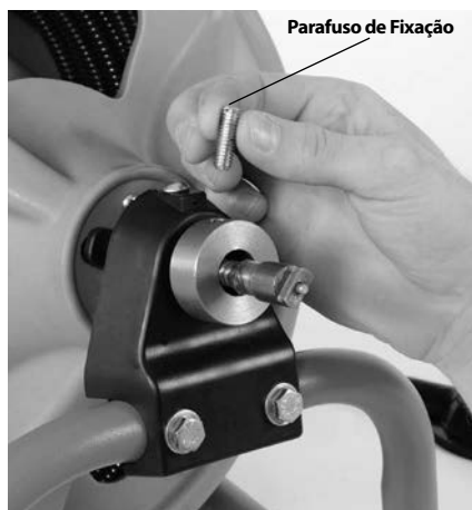
Figura 3 – Retire e elimine o Parafuso de Fixação de Bloqueio de Cabo
