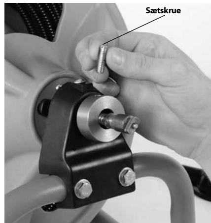
Figur 3 - Fjern og kassér sætskruen til spirallåsen
