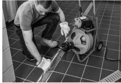
Figura 15 – Operarea K-400 cu dispozitivul AUTOFEED
