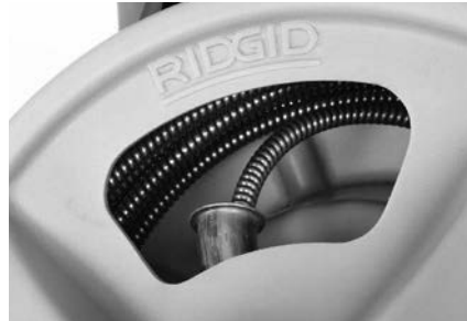
Figura 18 – Înfășurați cablul în tambur așa cum este ilustrat
