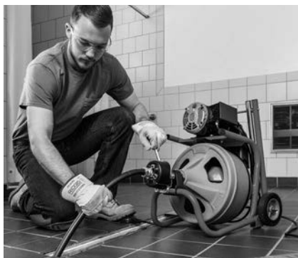
Figura 16 – Utilizzo della macchina con il Tubo guida
