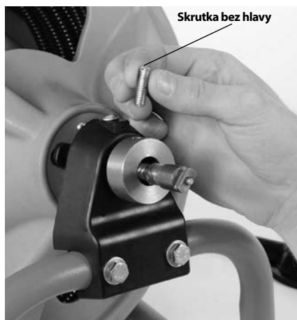
Obrázok 3 – Odstráňte skrutku bez hlavy slúžiacu na blokovanie špirály a zlikvidujte ju
