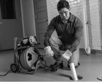
Şekil 10 – Makinenin Kablo Çıkışıdan 2' (0,6 m) Uzatılması Örneği
