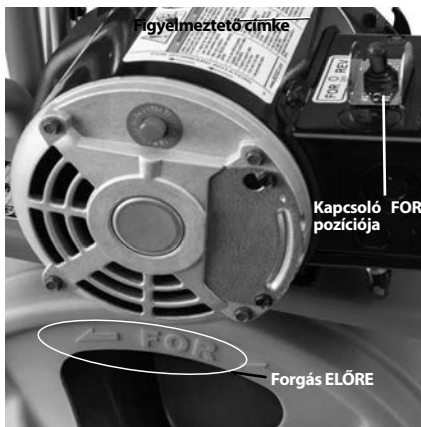
8. Ábra – A dob helyes forgásiránya (Kapcsoló pozíciója FOR)
