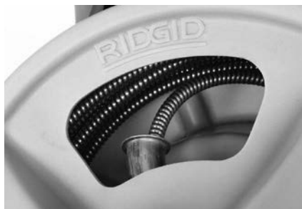
Εικόνα 18 – Περιέλιξη του σπιράλ στο τύμπανο όπως εικονίζεται
