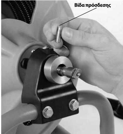
Εικόνα 3 – Αφαιρέστε και απορρίψτε τη βίδα πρόσδεσης σπирάλ
