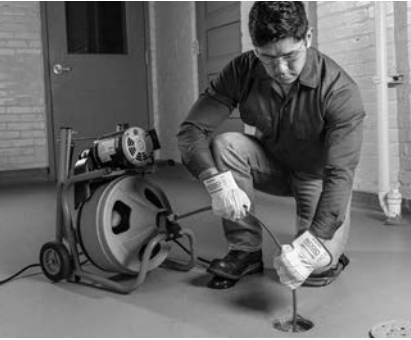
13-сурет – Жұмыс күйі, кабельді қолмен беру
