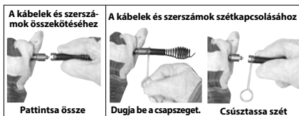
12. Ábra – Szerszámok fel- és lecsatlakoztatása
