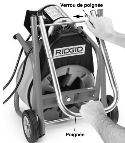
Figure 9 – Déploiement de la poignée
