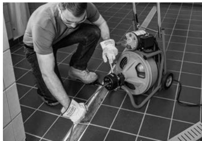
Slika 15 – Uporaba K-400 z AUTOFEED
