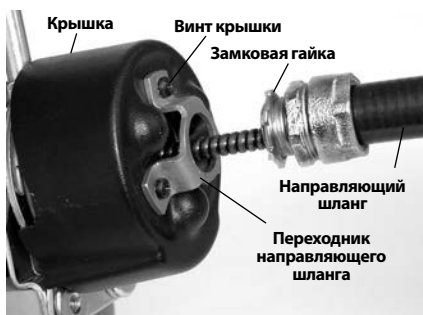
Рис. 6 – Крепление направляющего шланга к механизму подачи троса
