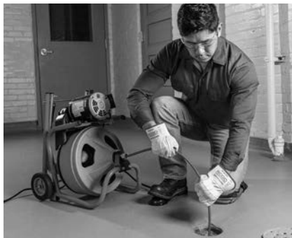
Obrázek 13 – V pracovní poloze, ruční posouvání spirály
