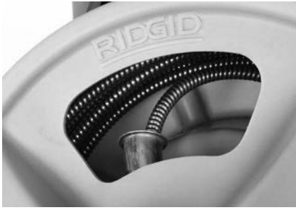
Slika 18 – Namotajte sajlu u bubanj kako je prikazano
