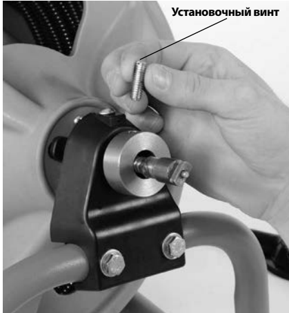
Рис. 3 – Выкрутите и утилизируйте установочный винт фиксации троса
