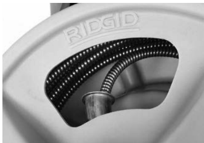
Kuva 18 – Kelaa avausjousi kelalle kuvan mukaisesti
