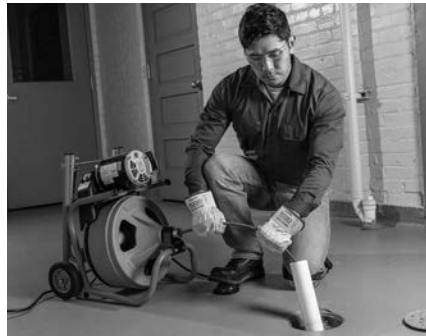
Kuva 10 – Esimerkki viemärin jatkamisesta 2' (0,6 m) päähän jousen ulostulosta.
