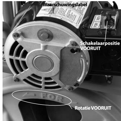
Figuur 8 – Correcte trommelrotatie (Schakelaarstand FOR (VOORUIT))
