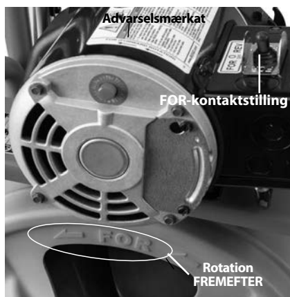
Figur 8 – Korrekt tromlerotation (kontakten er i positionen FOR)
