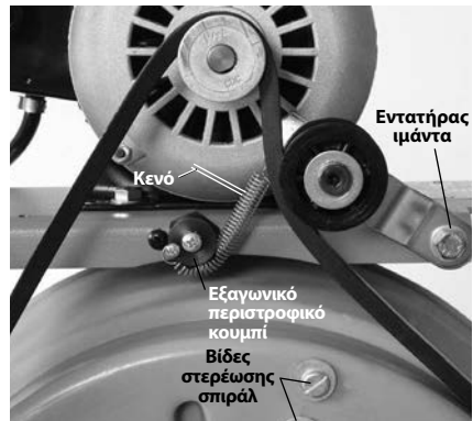
Εικόνα 17 – Ρύθμιση περιοριστή ροπής. (Εικονίζεται χωρίς το προστατευτικό του ιμάντα)
