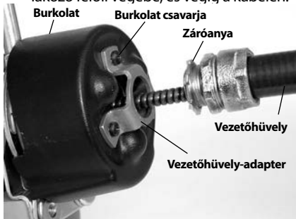
6. Ábra – A vezetőhüvely felszerelése a kábelelőtőlóra
