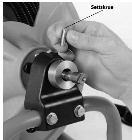
Figur 3 – Fjern og kasser kabellås-transportskruen
