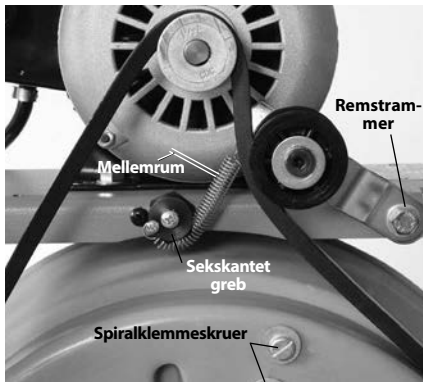
Figur 17 – Justering af torsionsbegrænser. (vist med remafskærmningen afmonteret)
