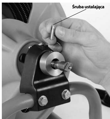
Rys. 3 – Wykręcić i zutilizować śrubę blokującą sprężynę
