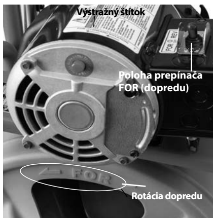
Obrázok 8 – Správna rotácia bubna (poloha prepínača FOR (DOPREDU))
