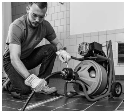
Figura 16 – Uso de la máquina con manguera-guía
