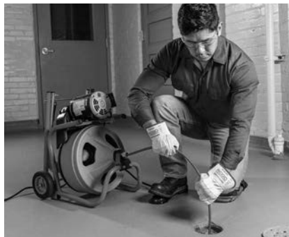
Figura 13 – In Posizione operativa, Inserimento manuale del cavo
