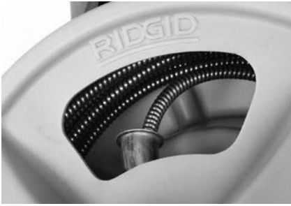
Abbildung 18 – Spirale in die Trommel wickeln, wie gezeigt
