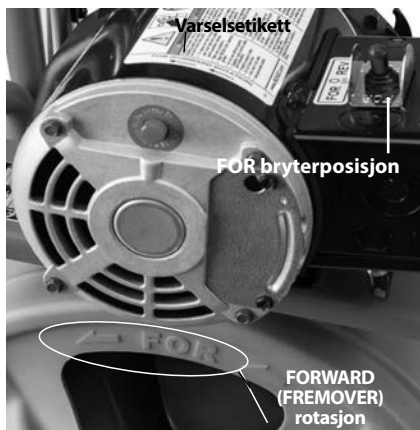
Figur 8 – Riktig trommelrotasjon (FOR-bryter posisjon)
