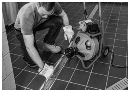
Figura 15 – Utilizar a K-400 com AUTOFEED (avanço automático)
