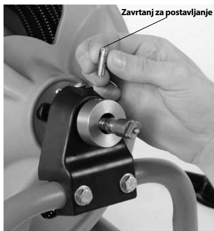
Slika 3 – Skinite i odbacite sigurnosni utični zavrtnaj sajle
