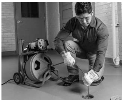
Obrázok 13 – V pracovnej polohe, manuálny posuv špirály
