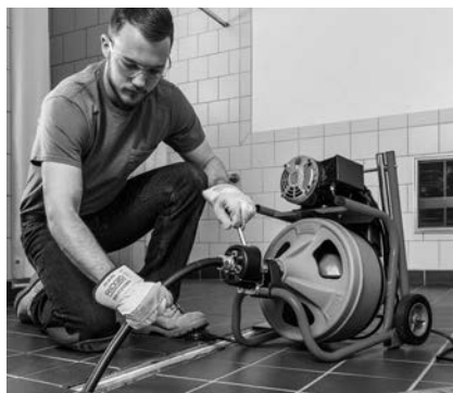
Kuva 16 – Laitteen käyttö suojaletkun kanssa
