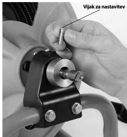
Slika 3 – Odstranite in zavrzite nastavne vijake zaklepa kabela
