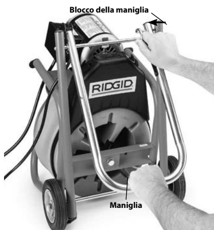
Figura 9 – Funzionamento della maniglia
