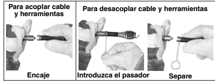
Figura 12 – Acoplamiento y desacoplamiento de herramientas al cable
