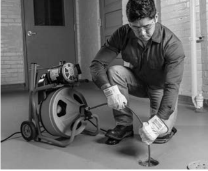
Şekil 13 – Çalıştırma Konumunda, Manüel Beslemeli Kablo
