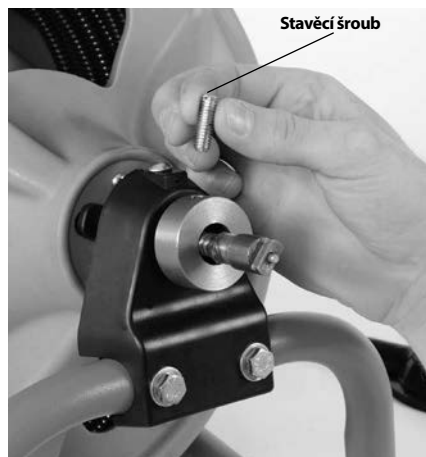
Obrázek 3 – Odstraňte a zlikvidujte stavěcí šroub uzávěru spirály
