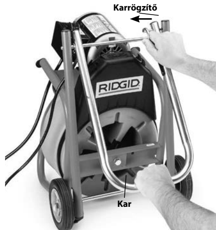
9. Ábra – A kar működtetése
