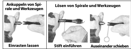
Abbildung 12 – Anschließen/Abnehmen von Werkzeugen
