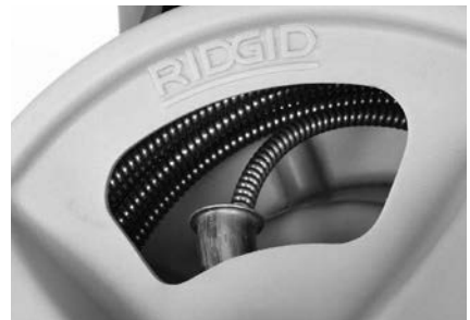
Şekil 18 – Spirali Makaraya Gösterildiği Gibi Sarın
