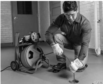
Abbildung 13 – In Betriebsposition, manueller Vorschub der Spirale
