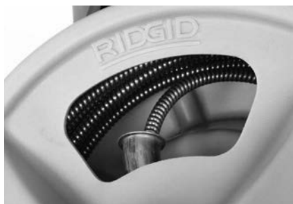
Obrázek 18 – Zobrazným způsobem naviňte spirálu do bubnu
