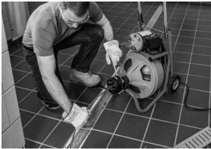
Slika 15 – Rad sa K-400 sa AUTOFEED
