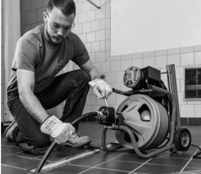
Slika 16 – Korišćenje mašine sa crevom za navođenje
