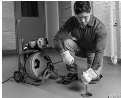
Slika 13 – U položaju rada, ručno uvlačenje sajle
