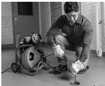
Figur 13 – Manuell spiralframmatning i arbetsläget
