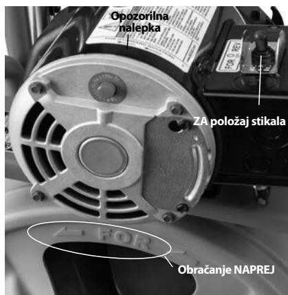
Slika 8 – Pravilno obračanje bobna (ZA položaj stikala)
