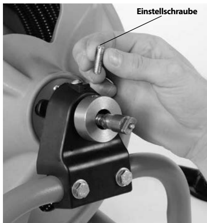
Abbildung 3 – Spiralsicherungsschraube entfernen und entsorgen
