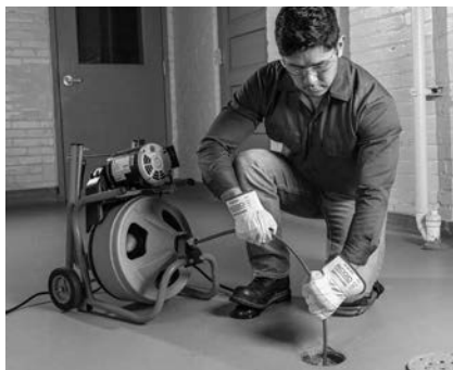
Figur 13 – Betjeningsposition, manuel indføring af spiralen
