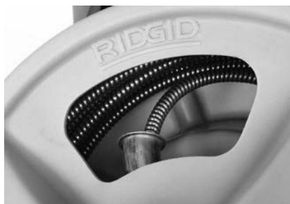
Rys. 18 – Układanie zwojów sprężyny w bębnie
