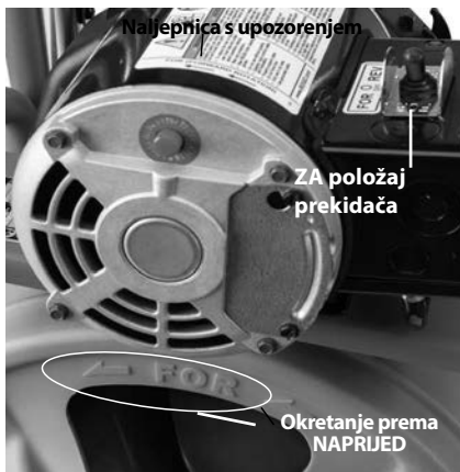
Slika 8 – Pravilno okretanje bubnja (ZA položaj prekidača)
