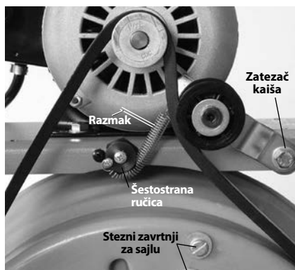
Slika 17 – Graničnik podešavanja obrtnog momenta. (Prikazano sa skinutim zaštitnim kaišem)
