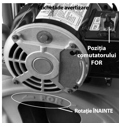
Figura 8 – Rotația corectă a tamburului (Poziția comutatorului FOR (ÎNAINTE))
