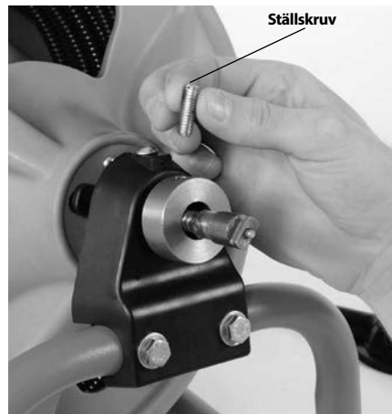
Figur 3 – Ta bort och kasta spirallåsskruven
