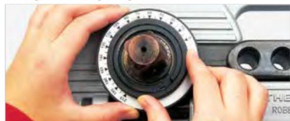
Werkzeuglose Voreinstellung des Biegewinkels
