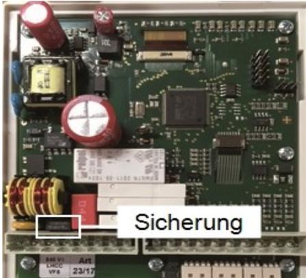
Hat der Regler trotz eingeschalteter Netzspannung keine Funktion und Anzeige, ist evtl. die interne Gerätesicherung defekt. Zuerst die externe Fehlerquelle (wie z.B. Pumpe) finden, austauschen und danach die Gerätesicherung überprüfen.
