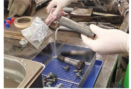
Reinigung mit STAR US 6 im Ultraschallreinigungsgerät
