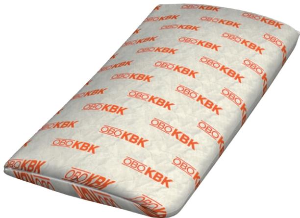
Kabel-Brandschutzkissen aus engmaschigem, dichtem und mechanisch festem Glasgewebe mit Spezialfüllung. Frei von Mineralfasern, wetterfest und wasserunempfindlich. In trockenen und frostfreien Räumen unbegrenzt lagerfähig.
