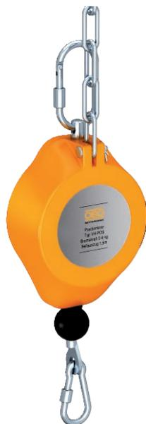
Positionierer zur variablen Höheneinstellung einer Versorgungseinheit VH, Traglast von 0,5 bis 6,0 kg, maximaler Seilauzug 1,5 m.
