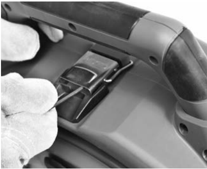
Abbildung 14 – Verschluss unter dem Tragegriff öffnen (mit Sechskantschlüssel)
