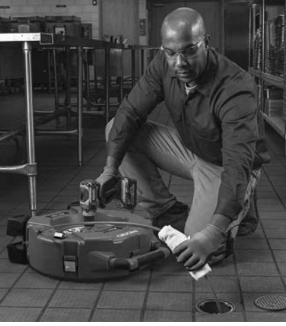
Şekil 13 – Kablo Kılıfına Yağlama Maddesi Uygulama
