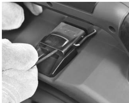
Figur 14 – Åbning af lås under bærehåndtag (ved hjælp af sekskantnøgle)
