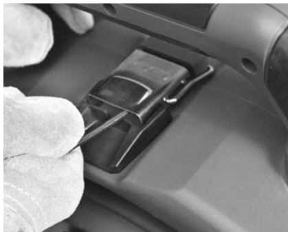
Рисунок 14 – Откройте защелку под ручкой для переноски (используйте шестигранный ключ)
