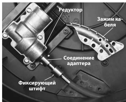
Рис. 15 - Корпус машины для прочистки канализации открыт
