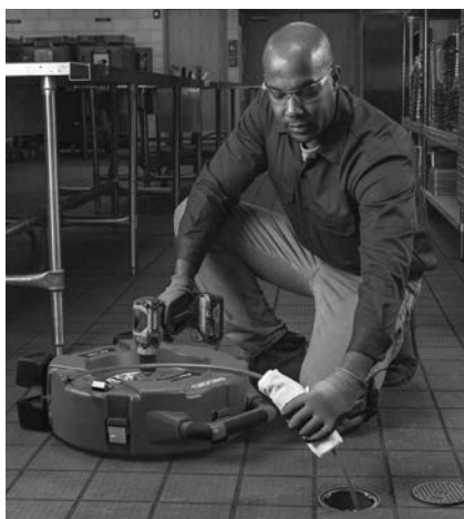
Slika 13 - Nanašanje maziva na ovoj kabla
