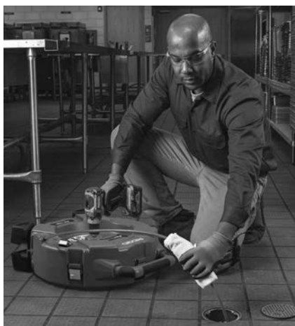
Slika 13 – Nanošenje maziva na oblogu sajle
