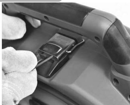
Slika 14 – Odprite zapah pod ročajem za nošenje (uporabite šestkotni ključ)
