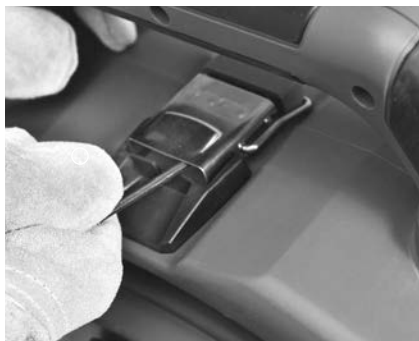
Figura 14 - Aprire il fermo sotto la maniglia di trasporto (usare la chiave esagonale)
