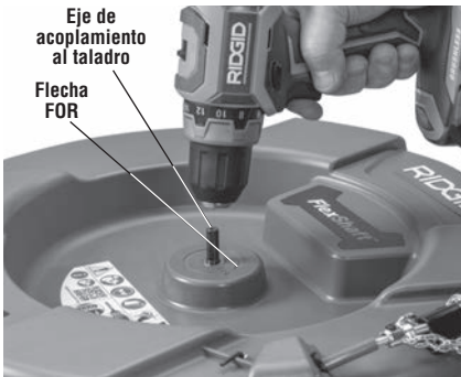
Figura 4 – Conexión del taladro al eje de acoplamiento
