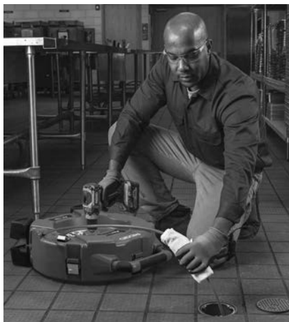
Εικόνα 13 – Εφαρμογή λιπαντικού στο περίβλημα σπιράλ
