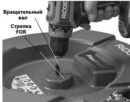
Рис. 4 - Крепление дрели к вращательному валу
