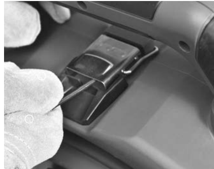
14. Ábra – Hordfogantyú alatti retesz nyitása (hatszögkulccsal)
