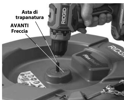
Figura 4 – Collegamento del trapano all'asta di trapanatura
