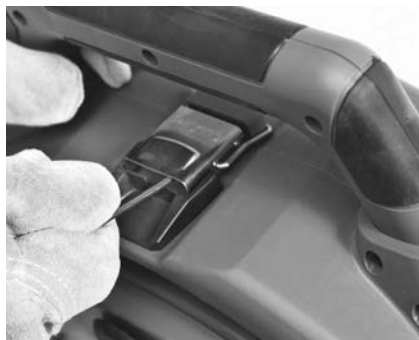
Figur 14 – Öppna spärren under bärhandtaget (använd sexkantsnyckeln)
