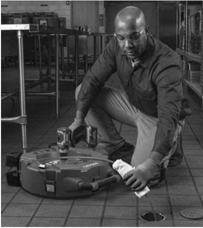
Figur 13 – Applicera smörjmedel på spiralhöljet
