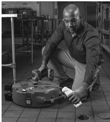
Рис. 13 - Нанесение смазки на оболочку троса
