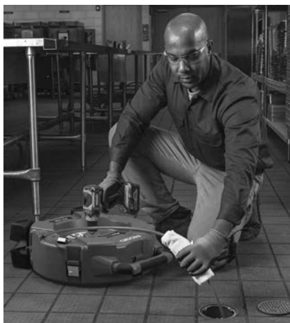
Slika 13 – Nanošenje maziva na izolaciju sajle
