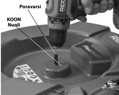
Kuva 4 – Poran kiinnittäminen pora-akseliin
