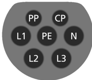
Abb. 2: Belegung des Typ-2-Steckers zum Anschluss an die Ladestation (EVSE)
