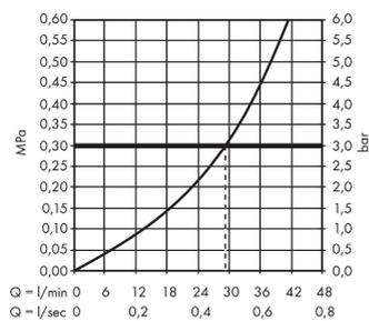
**Grundkörper 40 l/min für Abstellventil Unterputz Keramik DN15**
