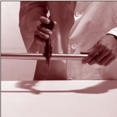
Fig. 21 | Schneiden der Rohre Pipe cutting
