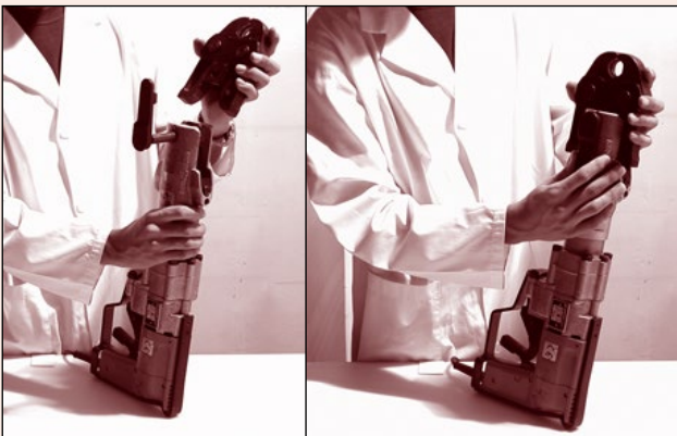
Fig. 27 | Ausrüstung der Presswerkzeuge Pressing tool assembly
