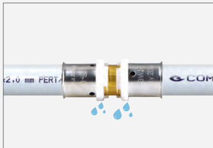
ZWISCHEN 1 UND 4,5 BAR GEPRÜFTER NIGHT VERPRESSTER FITTING - UNDICHT / RACCORDS NON SERTI, TEST EN PRESSION À 1-4,5BAR - IL FUIT
