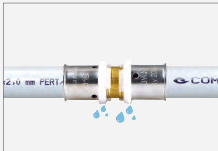
ZWISCHEN 1 UND 4,5 BAR GEPRÜFTER NICHT VERPRESSTER FITTING - UNDICHT / RACCORDS NON SERTI, TEST EN PRESSION À 1-4,5BAR - IL FUIT
