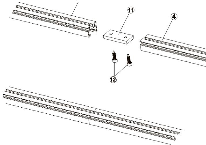
Das Verbindungsstück des Profils in Aluminiumprofile (11) der Montagesätze (4) einschieben und die Inbusschrauben anziehen (12).
