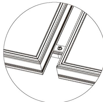
5. Seitlich werden die Kollektoren mit einer Kappe (6) und Schrauben (10) montiert (10).
