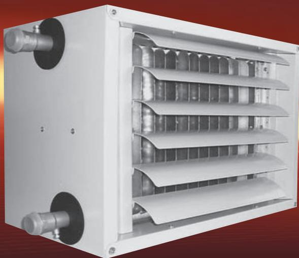
Ils sont compacts et peuvent être installés facilement sur un mur ou au plafond. Ils sont raccordés sur le réseau d'un chauffage central. La gamme Kroll est très large et offre des puissances de 10 à 203 kW par appareil. L'échangeur de chaleur intégré est fabriqué en cuivre/aluminium.
