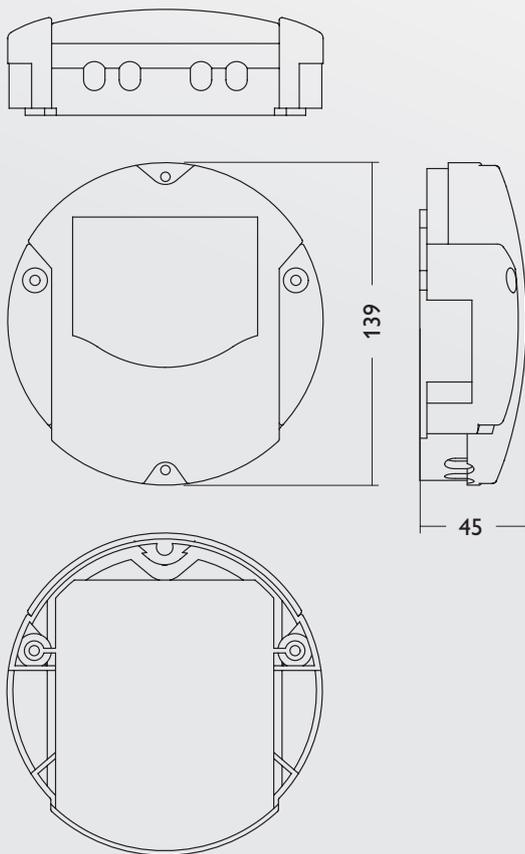
**Gehäuse:** Kunststoff, PC-ABS und PMMA
