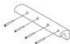
3. Fissare la staffa al muro verificando che le teste delle viti non sporgano dalla sede.
