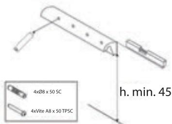
1. Posizionare la piastra sul muro ad una altezza consigliata di almeno 45cm. Verificare che la piastra sia a livello. Segnare con una matita la posizione dei 4 fori da dover praticare.
