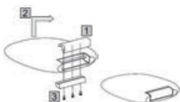
4. Inserire la seduta nella staffa e fissarla con le viti M4 in dotazione. Verificare che il movimento della seduta sia libero da impedimenti.
