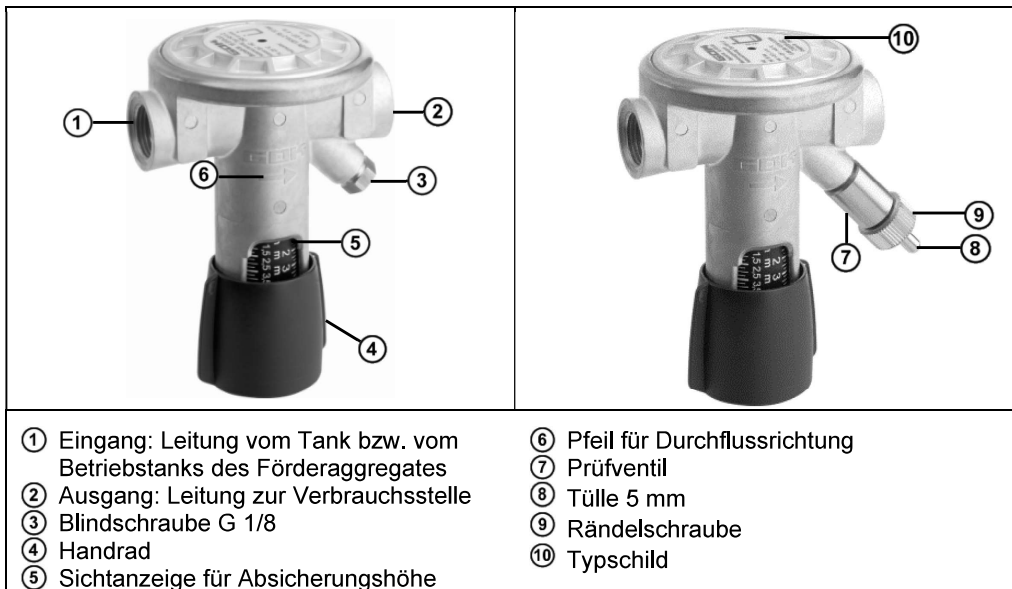
Abbildung 1: Aufbau Ausführungen mit Blindschraube oder Prüfventil
