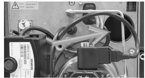
Abb./Fig. 8: Demontage Ansaugschalldämpfer
