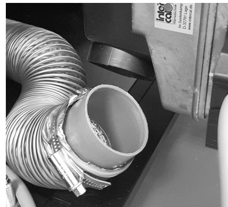
Abb./Fig. 12: Zuluftschlauch mit 50 mm Anschluss-Stück
