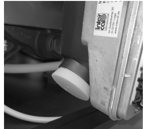
Abb./Fig. 7: Luft-Ansaugöffnung des Brenners BNR 100
