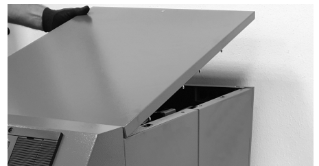
Abb./Fig. 3: Demontage der oberen Verkleidung
