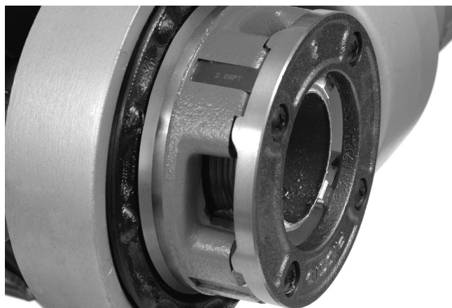
Figura 15 – Tubo allineato rispetto al margine dei pettini
