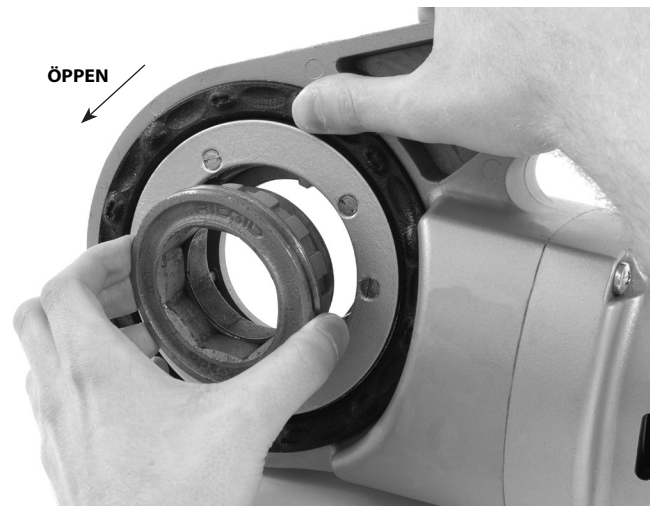
Figur 8 – Montering av adapter i 690-I
