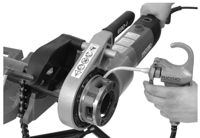
Obrázek 14 – řezání závitů na trubce
