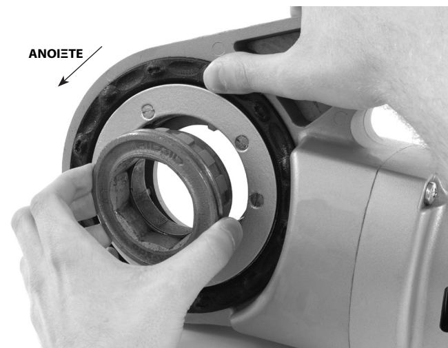
Εικόνα 8 – Τοποθέτηση προσαρμογέα στο 690-I
