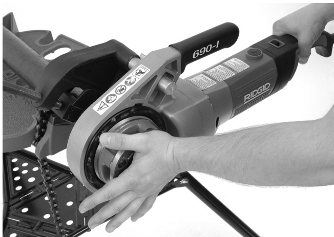
Figura 13 – Inicio del roscado
