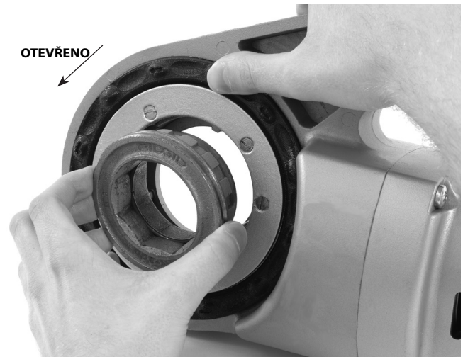
Obrázek 8 – instalace adaptéru do 690-I
