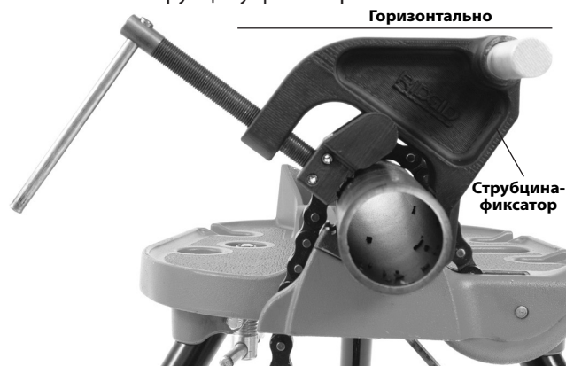
Рис. 11А – Расположение струбцины-фиксатора
