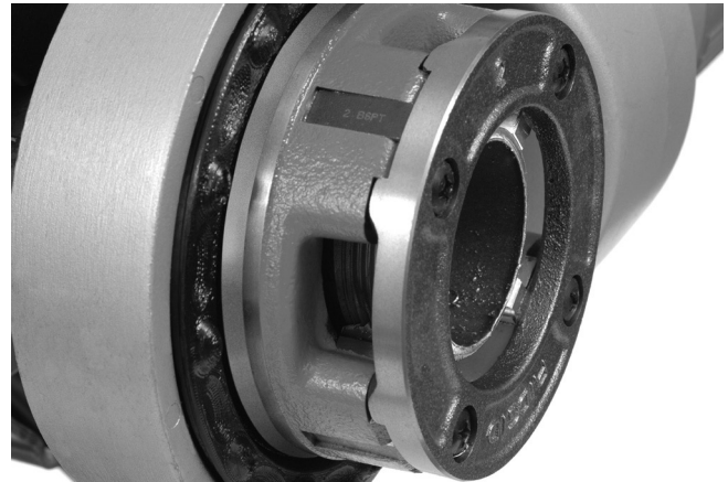
Figur 15 – Rør i niveau med skærkant på bakker
