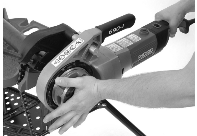
Şekil 13 - Diş Açmaya Başlama
