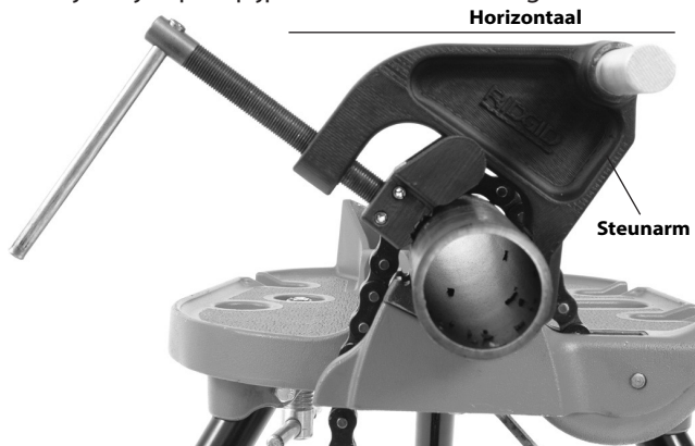
Figuur 11A – Aanbrengen van de steunarm
