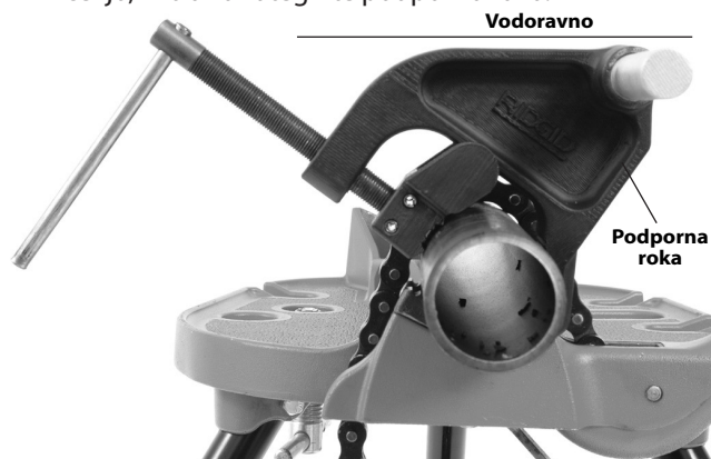
Slika 11A – Določanje položaja podporne roke
