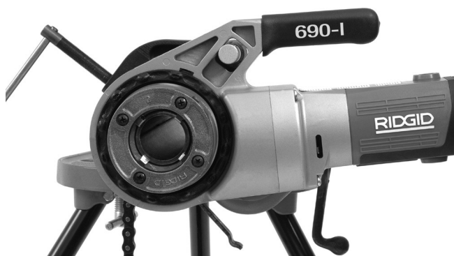
Figure 12 – Orientation appropriée du système d'entraînement
