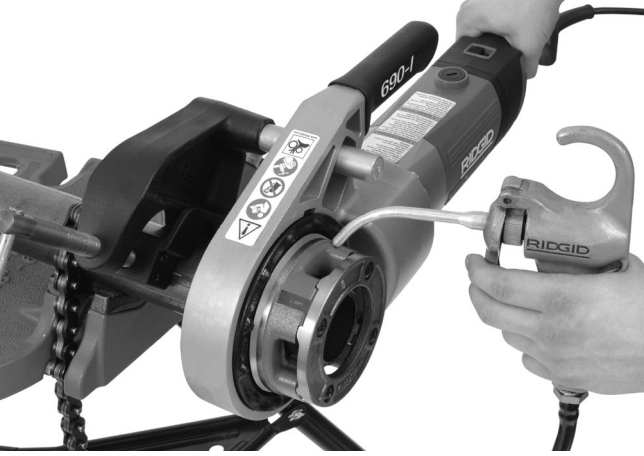
Şekil 14 - Boruya Diş Açılması
