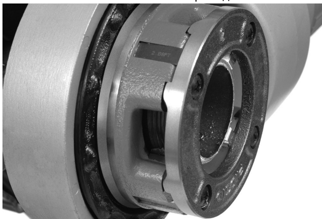
Рис. 15 – Торец трубы вровень с кромкой резьбонарезных гребенок
