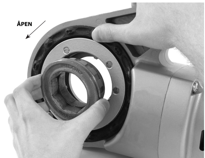
Figur 8 – installere adapter i 690-I
