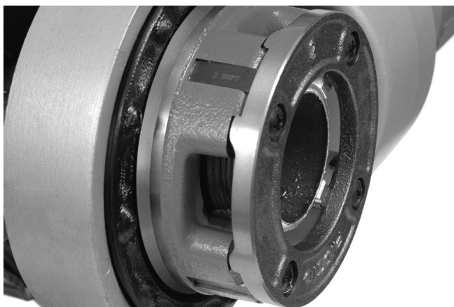
Figur 15 – rør jevnt med kanten på gjengebakkene
