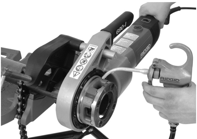
Figura 14 – Roscado de un tubo
