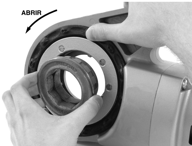
Figura 8 – Montaje del adaptador en la máquina 690-I
