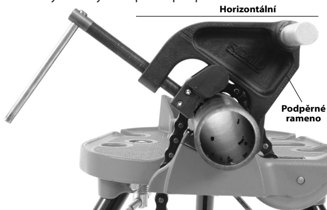
Obrázek 11A – umístění podpěrného ramene
