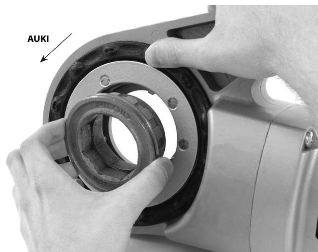
Kuva 8 – Välikappaleen asennus 690-I:een
