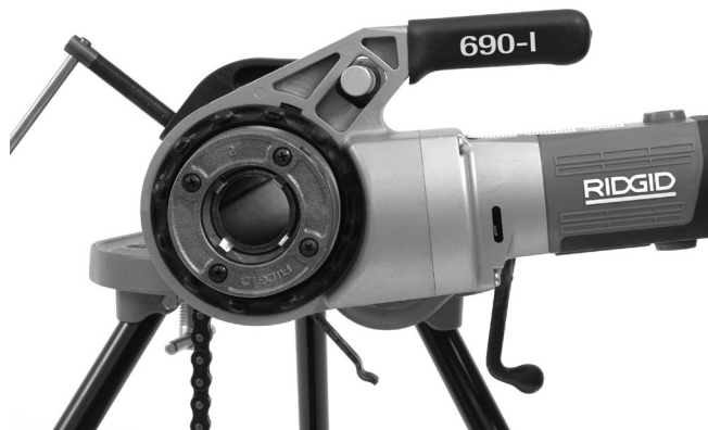
Figura 12 – Orientación correcta del accionamiento motorizado
