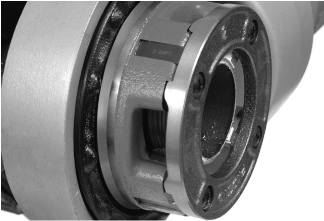
Εικόνα 15 – Σωλήνας στο ίδιο επίπεδο με το άκρο των μαχαιριών
