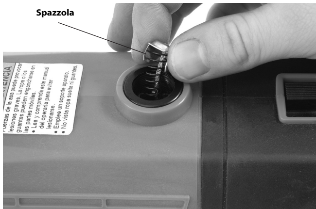
Figura 18 – Installazione della spazzola
