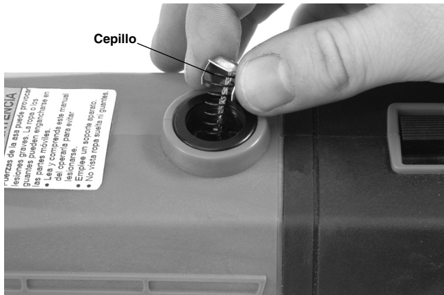
Figura 18 – Colocación del cepillo
