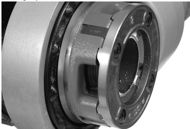
15. ábra – A cső a menetvágók szélével egy síkban van
