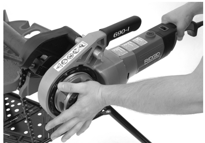
Figur 13 – Påbegyndelse af gevindskæringen
