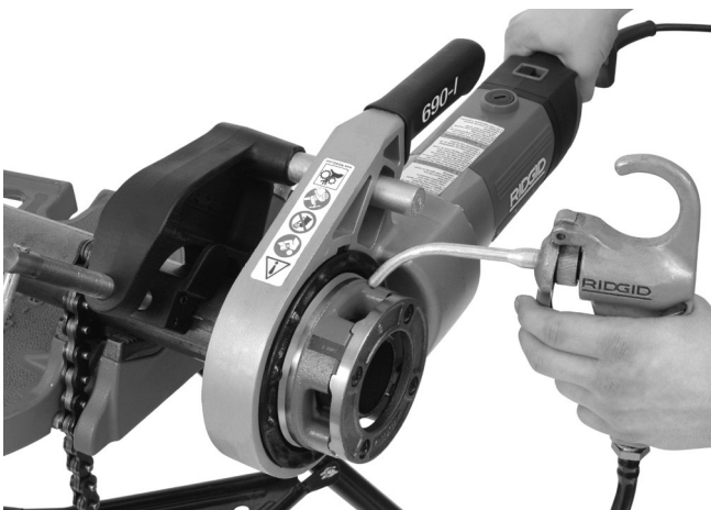
Figur 14 – Gevindskæring af rør
