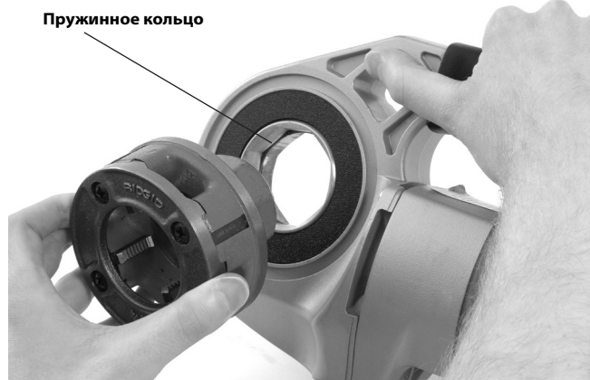
Рис. 9 – Установка резьбонарезных головок в силовой привод 600-I
