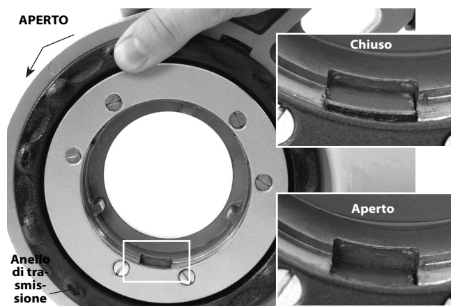
Figura 7 – Meccanismo di bloccaggio, Anello di trasmissione nella Posizione aperta/chiusa
