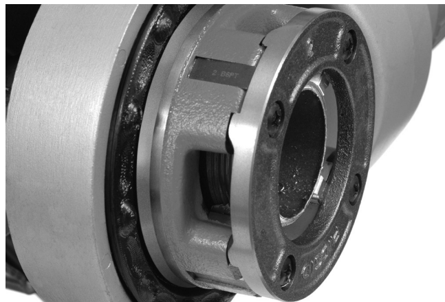
Figuur 15 – Pijp gelijk met rand van snijkussens
