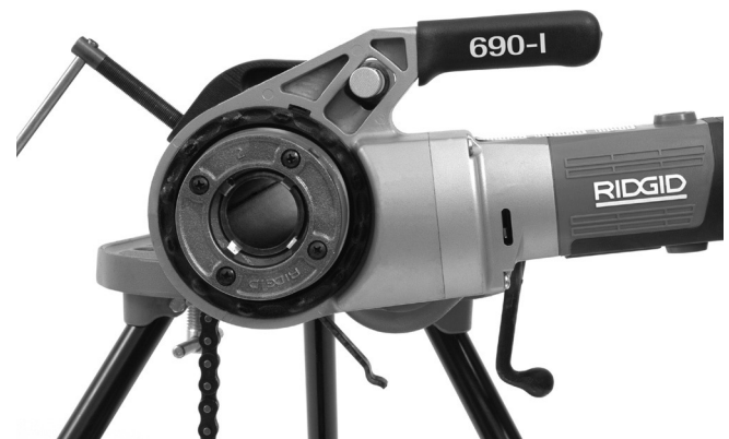
Figura 12 – Posizionamento corretto della Filettrice
