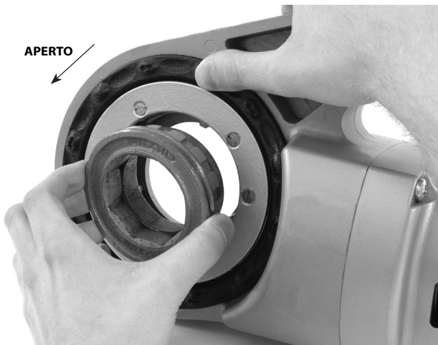
Figura 8 – Installazione dell'Adattatore nel 690-I
