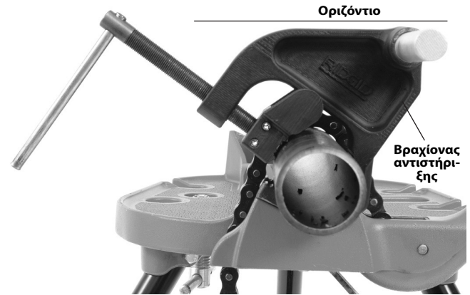
Εικόνα 11Α – Τοποθέτηση του βραχίονα αντιστήριξης
