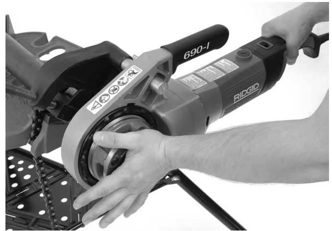
Obrázek 13 – začátek řezání závitů
