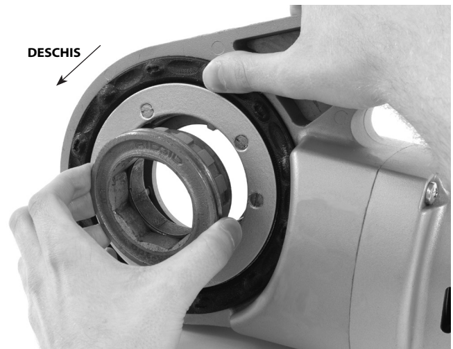
Figura 8 – Montarea adaptorului în 690-I
