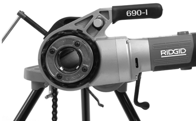
Рис. 12 – Правильное расположение силового привода
