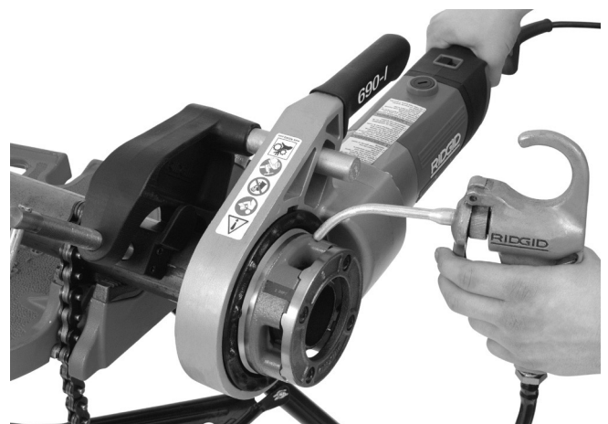
Obrázok 14 – Rezanie závitú na rúru
