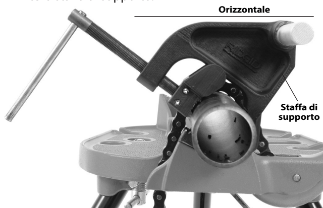
Figura 11A – Posizionamento della Staffa di supporto
