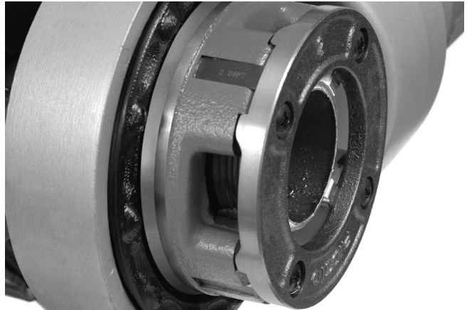
Abbildung 15 - Rohr mit Schneidbackenkante bündig
