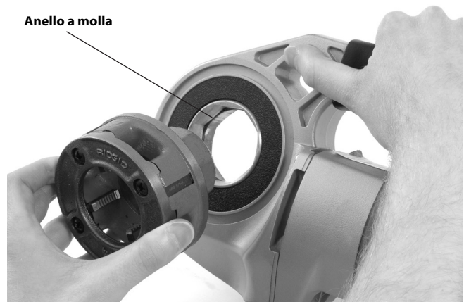
Figura 9 – Installazione delle Teste portapettini nel Filettrice 600-I
