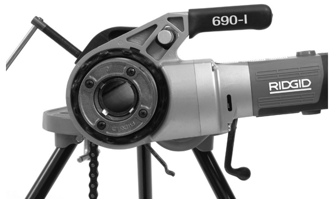
Figur 12 – Drivenhetens korrekta orientering
