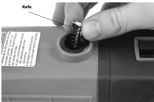
18. ábra – A kefék beszerelése
