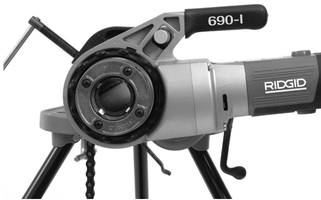
Figur 12 – korrekt orientering av håndgjengemaskinen
