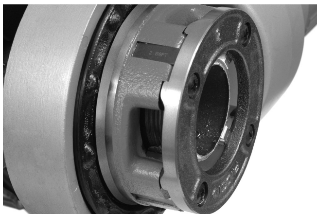
Figura 15 – Țeava la nivel cu marginea filierelor
