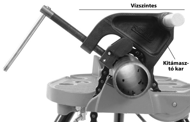
11A ábra – A kitámasztó kar pozicionálása
