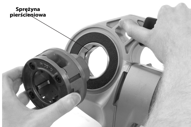
Rys. 9 – Montaż głowic gwinciarских na napęd elektryczny 600-I
