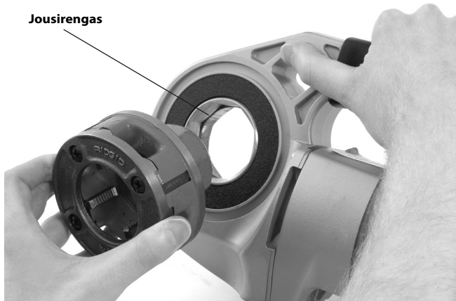
Kuva 9 – Kierrepäiden asennus 600-I-käyttölaitteeseen
