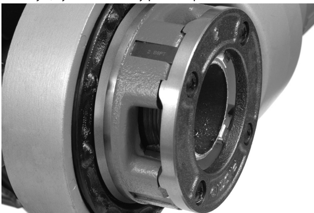
Obrázok 15 – Rúra vyrovnaná s hranou závitníc
