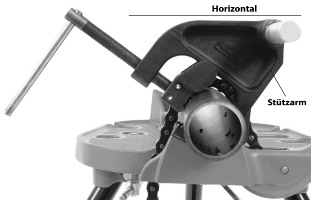
Abbildung 11A - Positionierung des Stützarms
