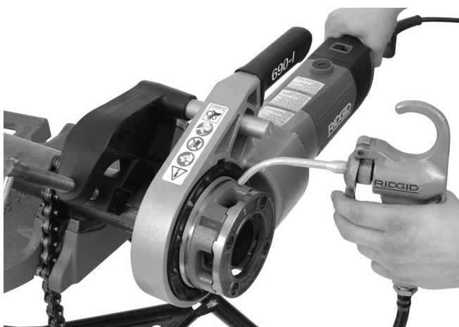
14. ábra – Menetvágás csőre
