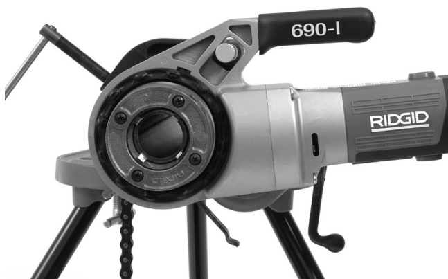
Figura 12 – Orientação Correcta do Propulsor
