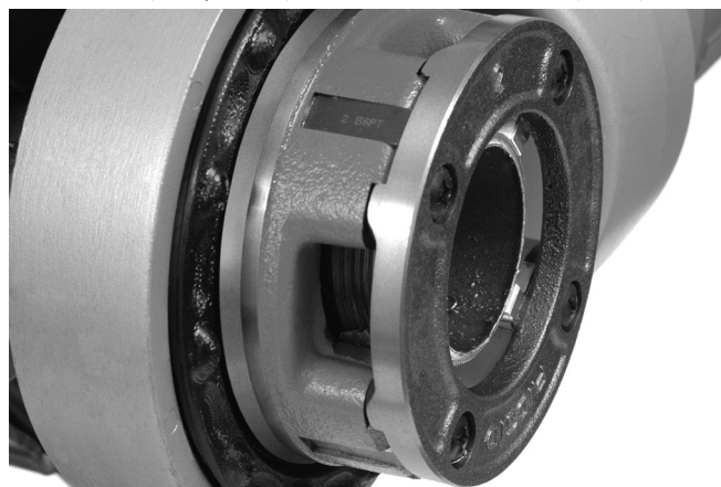
15-сурет – Құбыр кескіш жиектерімен бір деңгейде
