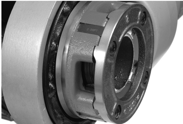
Figura 15 – Tubo Alinhado com Extremidade das Tarraxas
