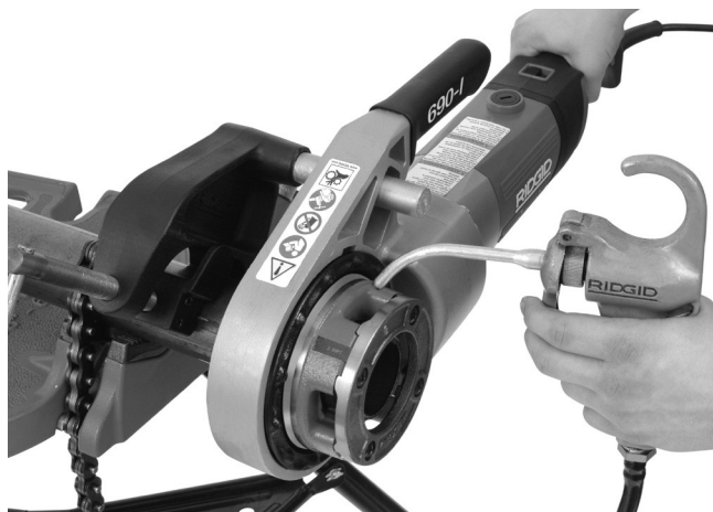
Figura 14 – Filettatura del tubo
