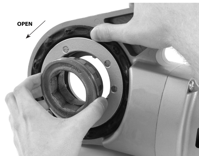
Figuur 8 – De adapter in de 690-I installeren
