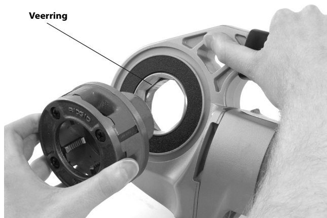
Figuur 9 – De draadsnijkoppen in de aandrijfmachine 600-I installeren
