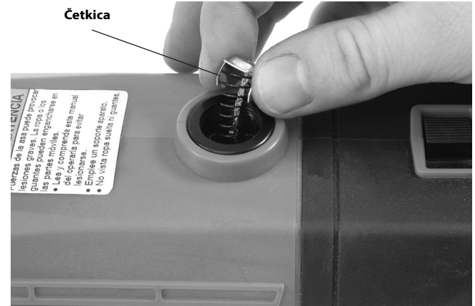
Slika 18 – Postavljanje četke
