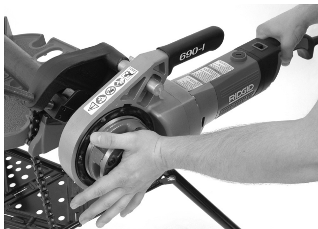
Рис. 13 – Начало нарезания резьбы
