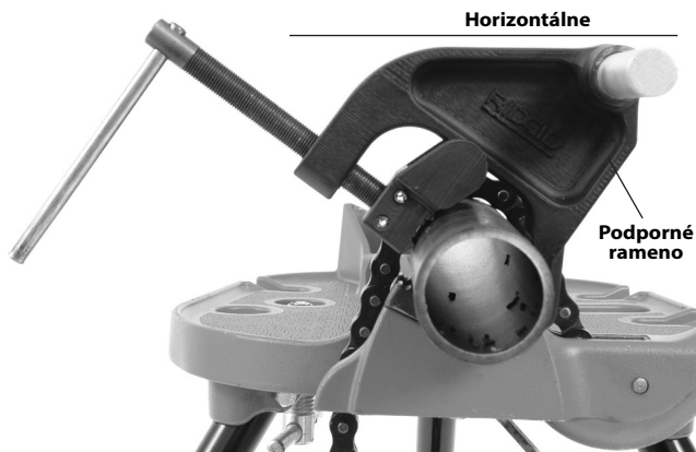
Obrázok 11A – Umiestnenie podporného ramena
