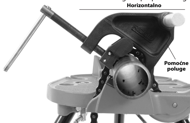
Slika 11A – Postavljanje potporne stege
