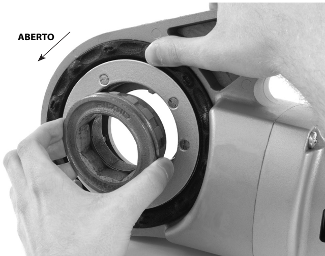
Figura 8 – Instalar Adaptador no 690-I
