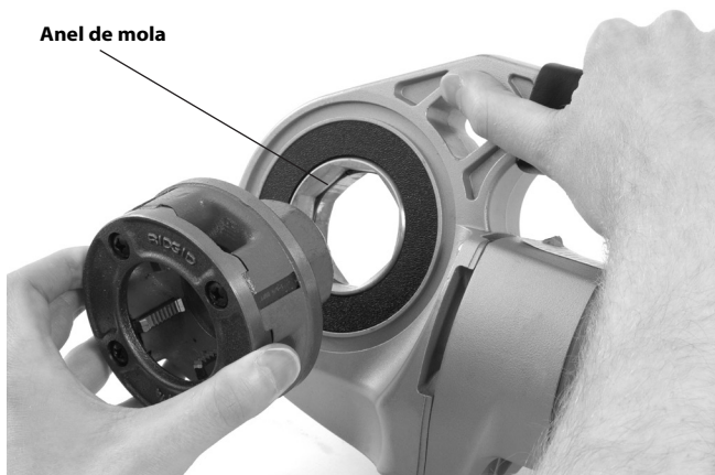
Figura 9 – Instalar Cabeças de rosca no Propulsor 600-I
