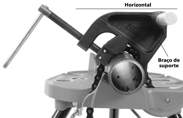
Figura 11A – Posicionar o Braço de Suporte
