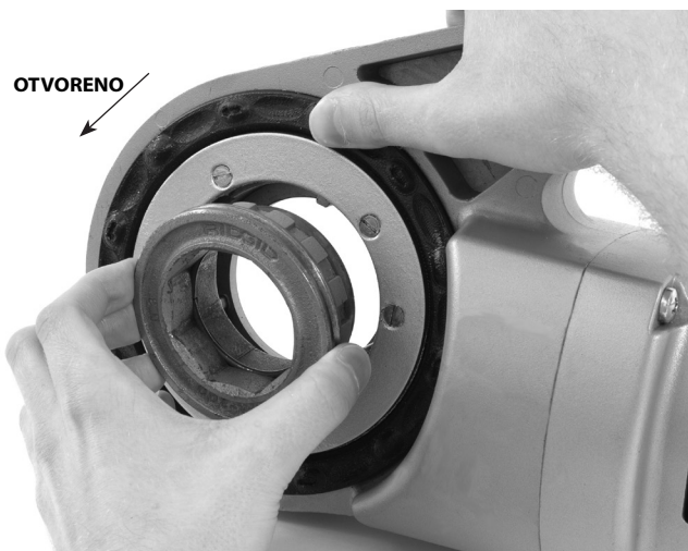
Slika 8 – Stavljanje adaptera u 690-I
